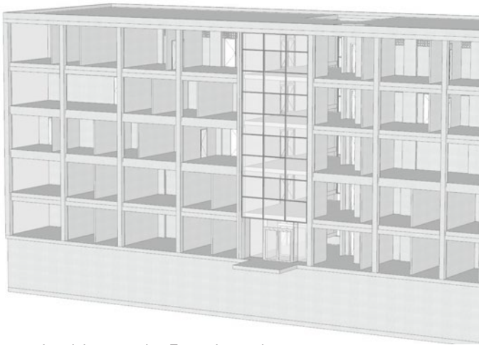
Abb. 33: Entfernen der nichttragenden Fassadenstruktur
