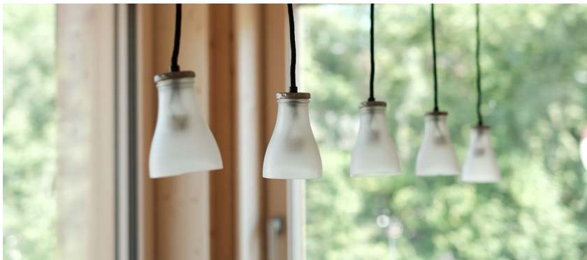
Abb. 316: Die Leuchten über dem Tisch wurden aus recycelten Milchflaschen und gängigen LED-Komponenten als Beispiel für Do-it-yourself hergestellt
