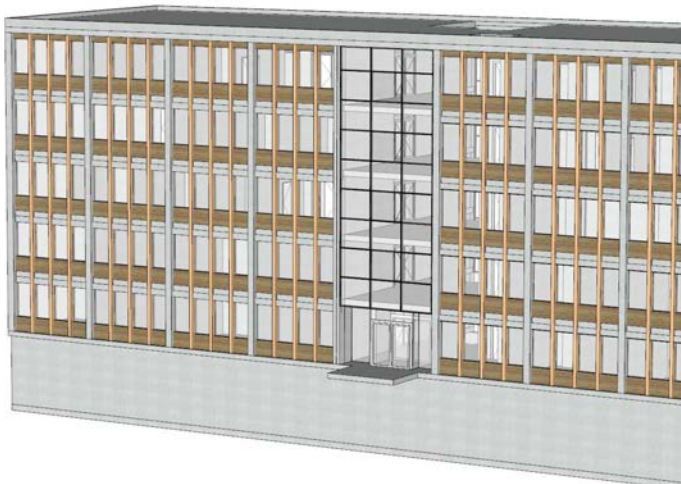
Abb. 34: Einsetzen der neuen Fassadenelemente aus Holz
