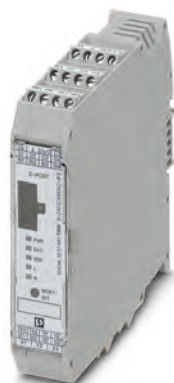
Abbildung 2.25: Hutschienengerät zur Über- oder Unterlasterkennung sowie weiteren Motormanagementfunktionen wie Leistungsmessung, Auswerten von Endschaltern, Ansteuerung von Schützen für das Ein- oder Abschalten des Antriebs oder Ansteuerung für die Stern-Dreieck-Umschaltung für bis zu 16 A für netzbetriebene Asynchronmotoren [Pho20]
