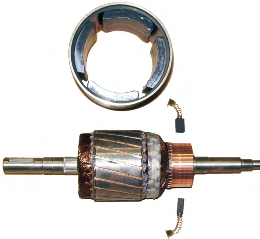
Abbildung 1.4: Zerlegter zweipolpaariger Gleichstrommotor: oben der Stator mit den aufgeklebten Magneten, unten der Rotor (Läufer) mit den Lamellen des Kommutators an der rechten Seite sowie die Kohlebürsten und Federn.
