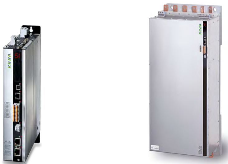
Abbildung 5.38: Servoregler für 400 V , links: Nennstrom 4 A, Höhe 30 cm, Luftgekühlt, in der linken Hälfte ist das Leistungsteil mit Anschlüssen für die Versorgungsspannung, Bremswiderstand und Motor, in der rechten Hälfte das Steuerteil mit Klemmen und Buchsen für Geber und Kommunikation; rechts: Nennstrom 450 A, Höhe 95 cm, Flüssigkühlung, ebenfalls rechts oben das gleiche Steuerteil mit Geber- und Kommunikationsschnittstellen [KEB20]
