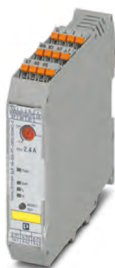
Abbildung 2.18: Gerät zum direkten Schalten (Zuschalten und Trennen vom Netz) von Asynchronmotoren mit Drehrichtungswahl bzw. Drehrichtungsumkehr und Motorschutzfunktion zur Montage auf einer Hutschiene [Pho20]
