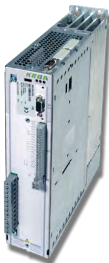
Abbildung 5.37: Frequenzumrichter mit Positionierfunktion für 7,3kW, Höhe ca 25 cm [KEB20]: links auf der linken Geräteseite die Leistungsklemmen (Spannungsversorgung, Motoranschluss); auf der rechten Geräteseite oben und vorne Anschlüsse für die Kommunikation (24 V und Bussysteme)
