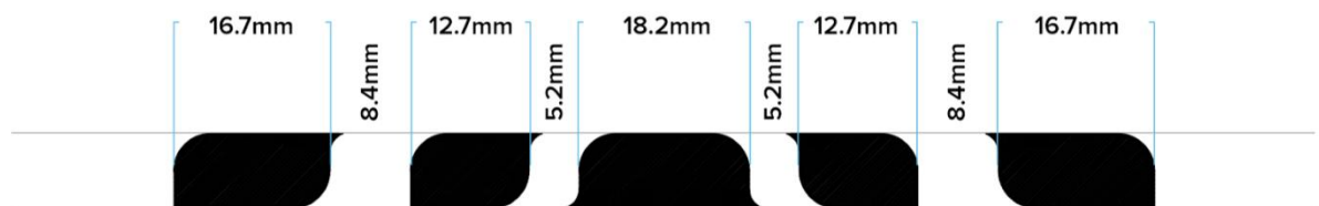
Abbildung 9: Messungen zwischen den Kanalelektroden am MUSE (Quelle: https://web.archive.org/web/20180418072714/http://developer.choosemuse.com/hardware-firmware/hardware-specifications [aufgerufen am 02.10.19])
