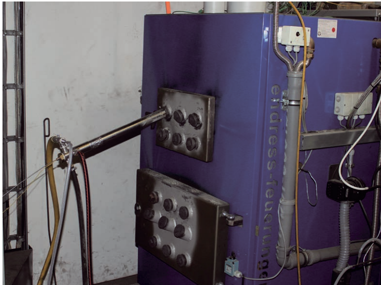
Vermessung der Brennraumtemperatur mittels Absaugpyrometer
