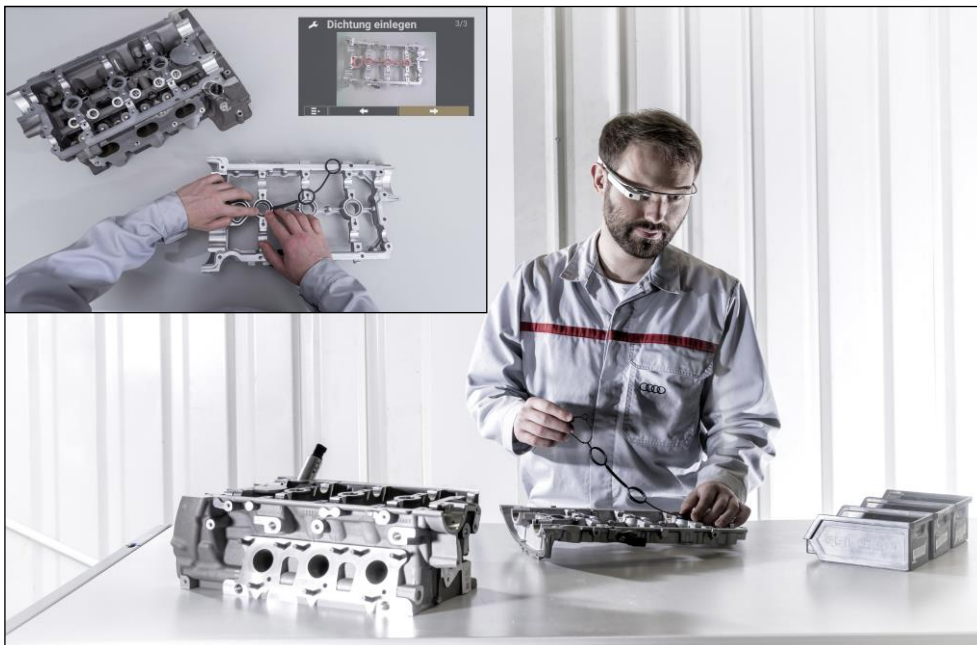
Abbildung 9: Einsatz von Augmented Reality Brillen in der Motorenmontage bei Audi 75
