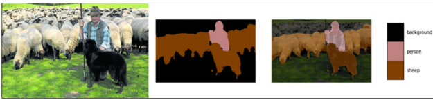
Abbildung 17: Fehlergebnis das durch Atrous- Faltung ausgelöst wurde [10] [12]
