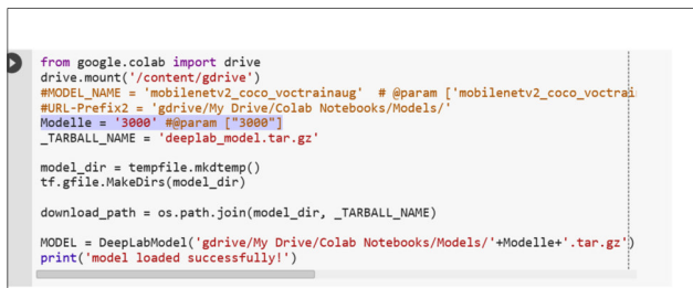
Abbildung 13: Codeabschnitt, in dem ein neues Netz eingebunden werden kann [10]
