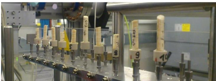
**Abb. 3:** Ausgewählte Bohrkern-Proben für die SR $\mu$ CT-Untersuchungen
