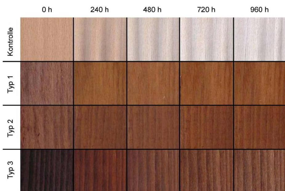
**Abbildung 1.** Visuelle Erfassung der Farbänderung der PF imprägnierten Prüfkörper und der Kontrollprobe über den Bewitterungszeitraum.
