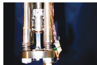
Kyrostat mit eingespanntem Siliziumkristall
