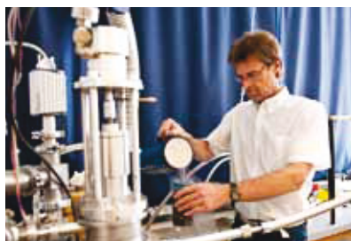
Prof. Hans-Christian Alt kühlt für seine Messung die Proben mittels Flüssigstickstoff ab
