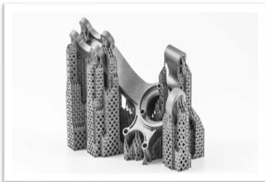
Abbildung 6: Automatisch generierte Stützstruktur eines Metallteils (Griffith Laura, 2019)
