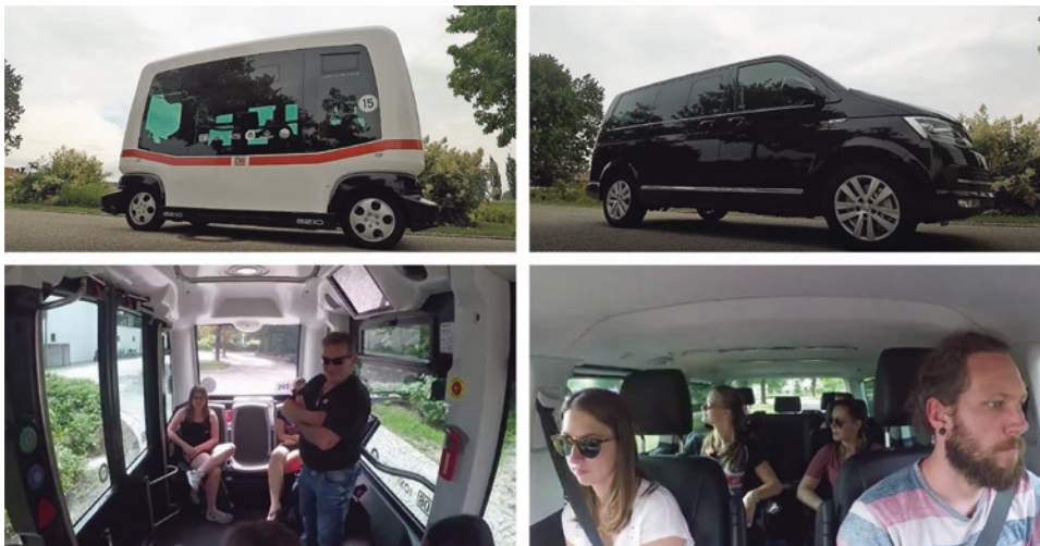
Abb. 6.1 Automatisiertes Shuttle (EasyMile EZ10, links) sowie das für den Vergleich verwendete manuell gesteuerte Gruppentaxi (VW Multivan, rechts), jeweils inkl. Innenraumaufnahme
