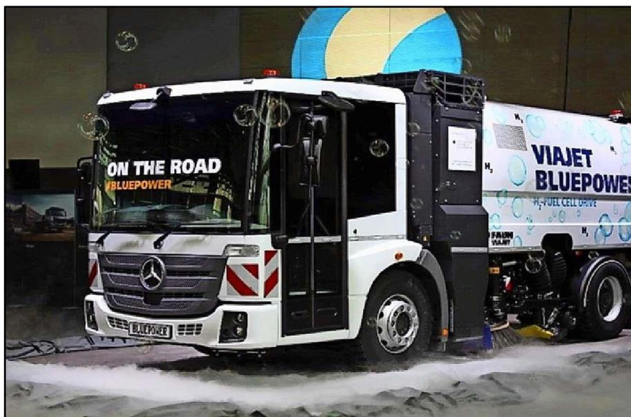
Abbildung 32: Kehmaschine mit Brennstoffzelle.<sup>140</sup>
