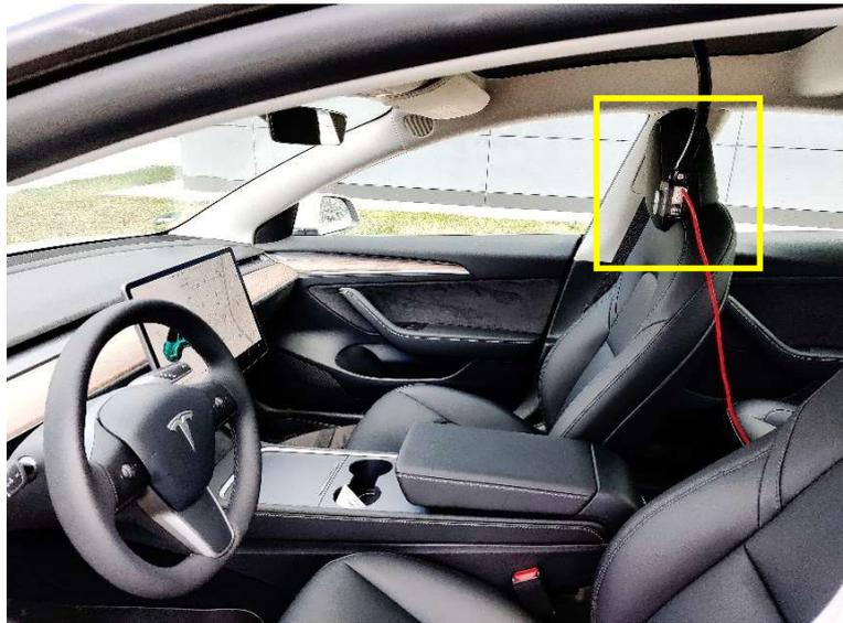
Abbildung 16: Darstellung des Aufbaus der Go Pro Hero 8 im Innenraum in der Seitenansicht des Tesla Model 3
