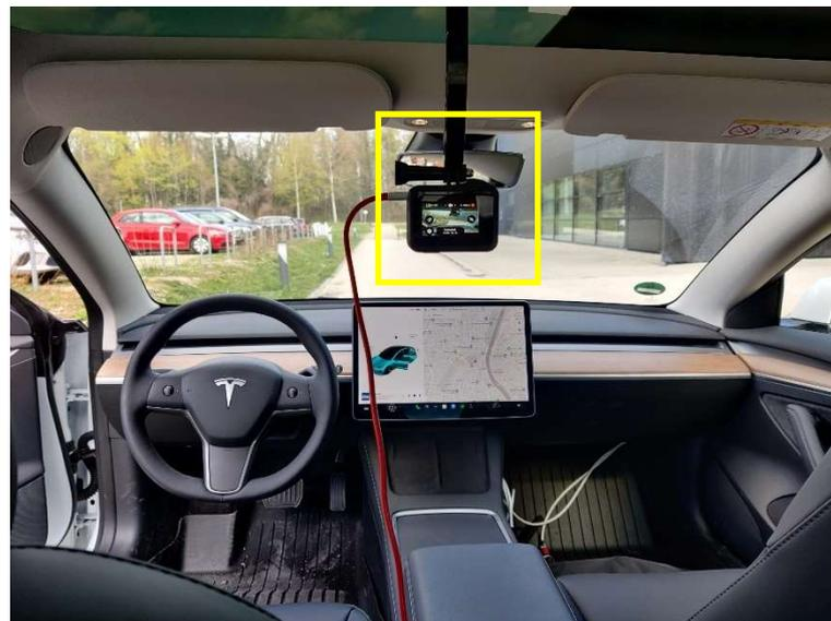
*Abbildung 14: Darstellung des Aufbaus der Go Pro Hero 8 im Innenraum in der Vorderansicht des Tesla Model 3*
