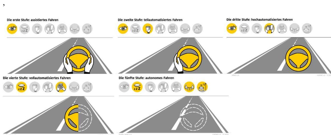
Abbildung 3: Unterschiede der erlaubten Tätigkeiten des Fahrers je nach Automatisierungsstufe nach [8]
