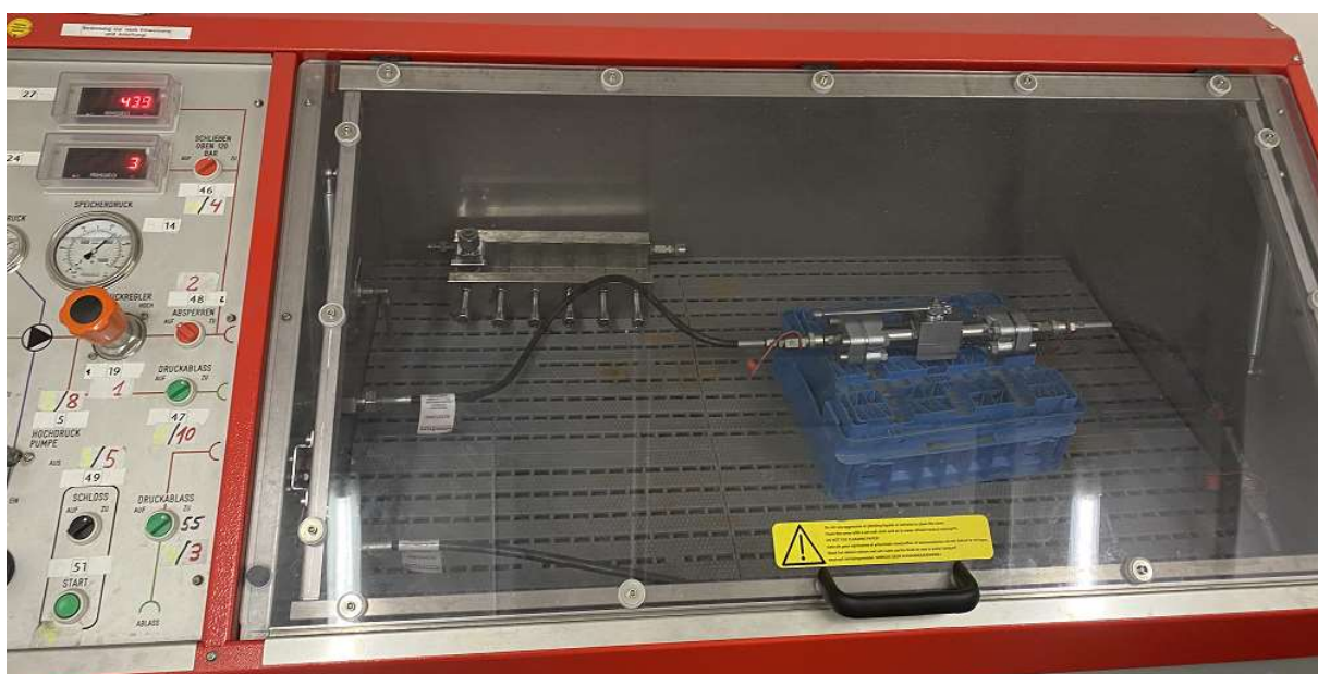
Bild 10: Steigende Druckbelastung bei Kugelhahn bei interner Druckprüfung
