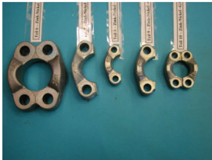
Bild 11: ZnNi beschichtete Voll- und Halbflansche nach 360h Salzsprühnebeltest
