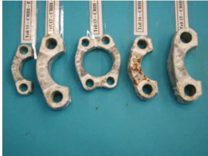
Bild 12: CR3 beschichtete Voll- und Halbfansche nach 360h Salzsprühnebeltest
