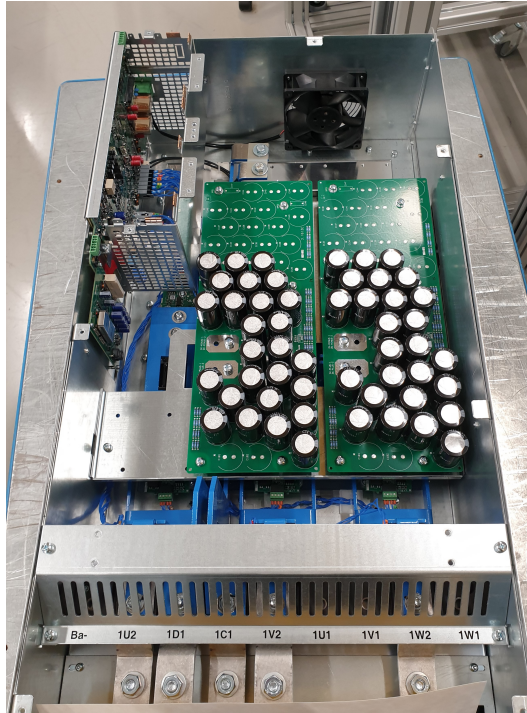
Abbildung 1.5: Fertigungsmomentaufnahme Servoumrichter Baugröße 6
