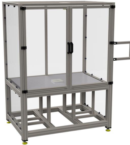
Abbildung 2.2: Konstruierte Roboterzelle für die Bestückung
