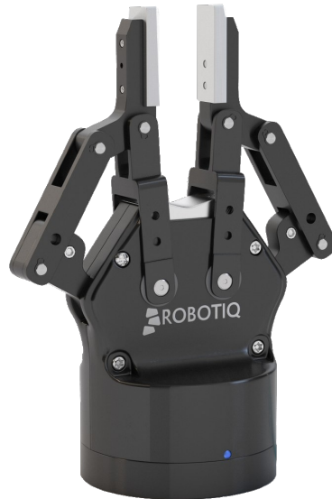
Abbildung 2.6: 2-Finger-Greifer der Firma Robotiq. Angelehnt an Quelle [26]
