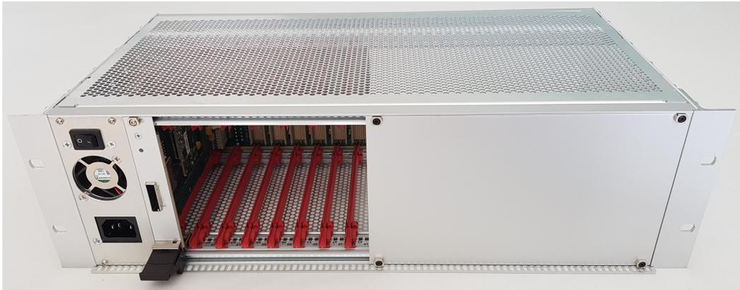
Abbildung 5: PCIe Expand System Hybrid
