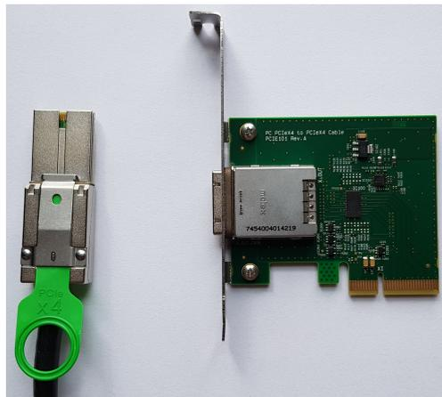
Abbildung 6: PCIe Verbindungskarte und Kabel
