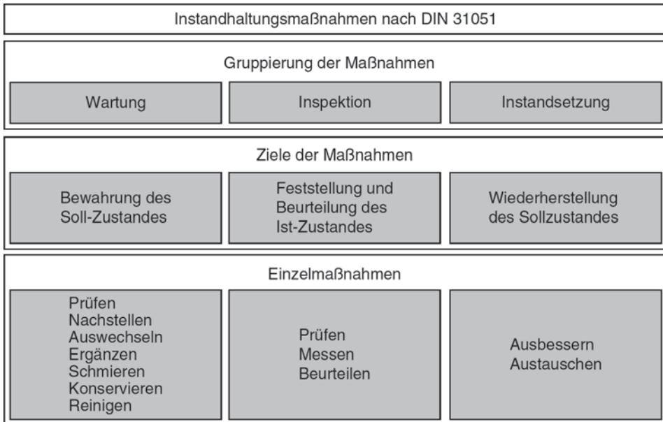
Abb. 11.36 Instandhaltungsmaßnahmen nach DIN 31051
