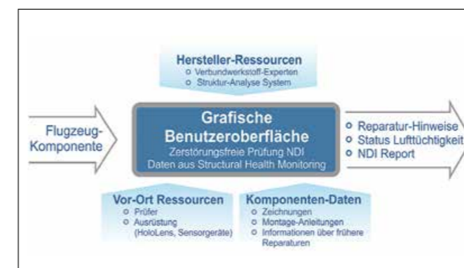
Abb. 3: Informationsfluss über die AR-Schnittstelle bei einer Schadensauswertung und Bewertung (Quelle: DLR)
