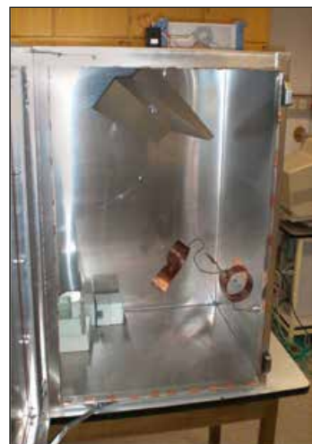
Abb. 1: Elektromagnetische Modenverwirbelungskammer mit Modenrührer und Antennen zur Ein- und Auskopplung elektrischer Leistung
