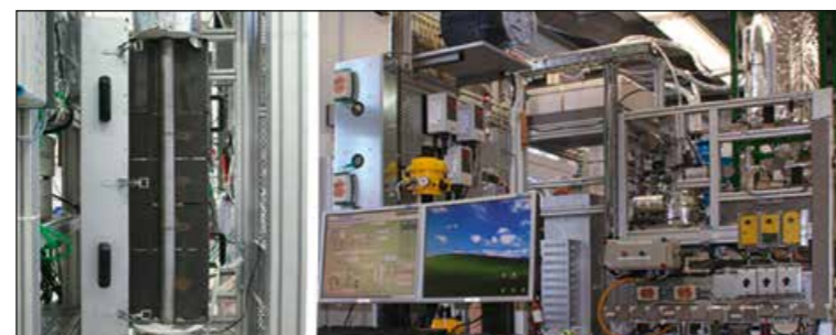
Abb. 2: Rieselbettreaktor (links) als Teil einer ersten Versuchsanlage an der TU Bergakademie Freiberg (rechts)
