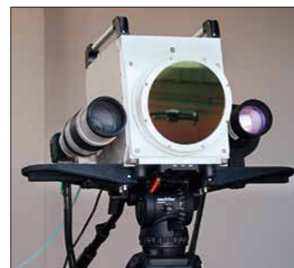
Abb. 3: Multispektrale Kameras auf einem Videostativ: v. l. n. r. visuelles Hochgeschwindigkeits-, Wärmebild- und Infrarotkammerasystem
