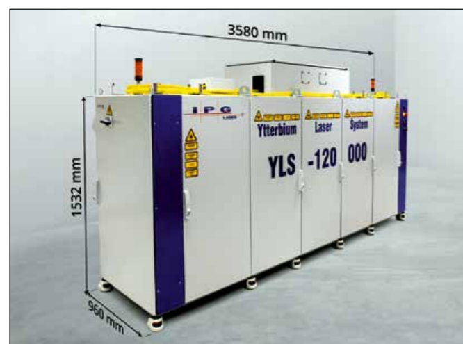
Abb. 1: Industrielaser mit einer Leistung von bis zu 120 kW
