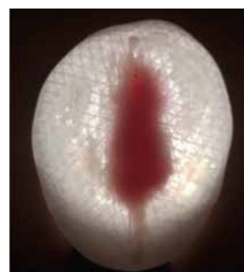
Abb. 2: FDM Modell des VEDH. Umsetzung des Modells aus Abb. 1 durch FDM Druck. Nach Beleuchtung des semi-transparenten Materials von unten
