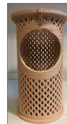
Abb. 3: Im FFF-Verfahren hergestellter Seefiltereinsatz für Korvette K130 aus Thermoplastischem Polyurethan (TPU) 98A
