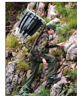
Abb. 4: Rucksacksystem der KEAN Antenne zum einfachen Transport in steilem und unwegsamem Gelände (Quelle: HPS GmbH)
