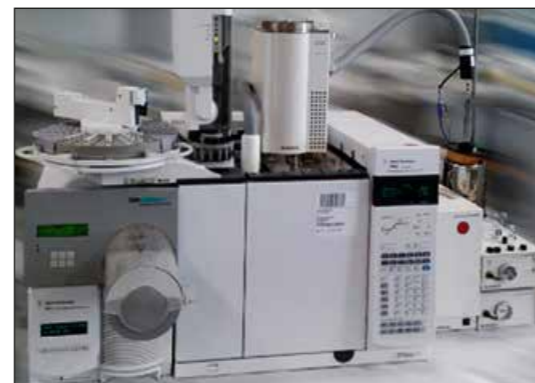
Abb. 2: Gaschromatograph/Massenspektrometer (GC/MS) zur Untersuchung der chemischen Zusammensetzung von Elastomeren.
