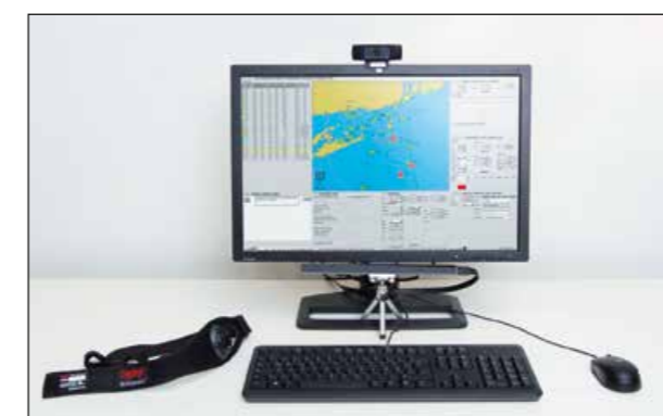
Abb. 3: Demonstrator mit Brustgurt (links) und Eyetracker (unterhalb des Monitors) zur Nutzerzustandsdiagnose
