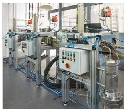
Abb. 2: Hochdruckautoklav (Crawford-Bombe) zur Ermittlung der druck- und temperaturabhängigen Abbrandgeschwindigkeit von Festtreibstoffen
