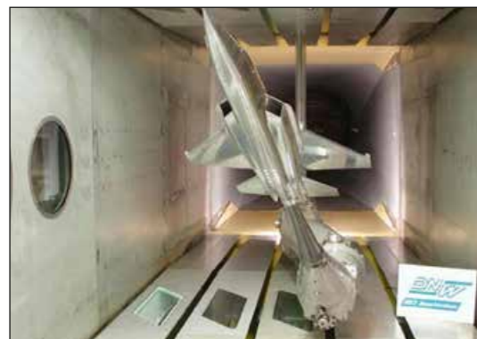
Abb. 1: Windkanalmodell einer betrachteten experimentellen Geometrie (Quelle: MAKO – EADS, © Airbus Defence & Space)
