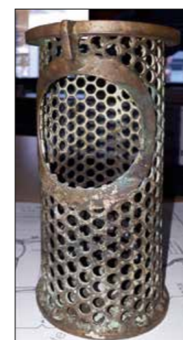
Abb. 2: Originaler Seefiltereinsatz für Proviantkälteanlage Korvette K130 mit Korrosionserscheinungen
