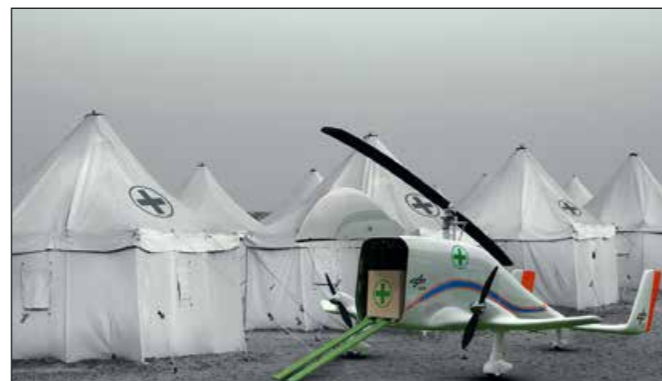
Abb. 2: Eine Nutzlast von 1000 kg ist das Ziel für eine einfach beladbare, kostengünstige Drohne für den unbemannten Frachttransport
