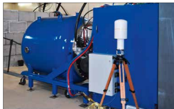
Abb. 2: Aufbau des Neutronengenerators am WIS (Quelle: WIS Munster)
