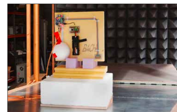
Abb. 3: Testaufbau im TEM-Wellenleiter am Fraunhofer INT
