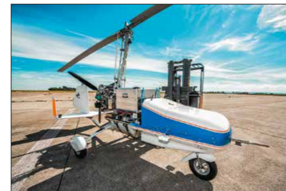
Abb. 3: ALAADy-Demonstrator – Skalierter Prototyp zur Erforschung der Technologien für den unbemannten Frachttransport
