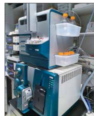
Abb. 3: Wichtigste Techniken zur Verifikation: Chromatographie in online-Kopplung mit Massenspektrometrie
