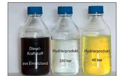
Abb. 5: Dieseldieselkraftstoff aus Mali (links), Produkt nach hydrierender Entschwefelung bei unterschiedlichen Drücken (Mitte und rechts)
