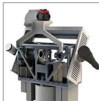
Abb. 2: 3D CAD Simulation der Schwenk- und Neigemontierung (PTU) mit Kamerasystemen
