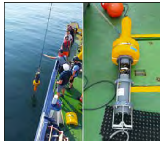
Abb. 1: Meßboje der Firma Jasco Applied Sciences, mit Einzelhydrophon (rechts); Ausbringen der Boje vom FS ELISABETH MANN BORGESE (links)
