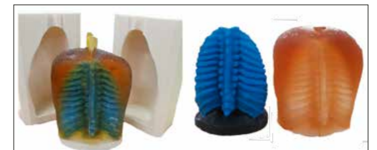
Abb. 4: Gussform mit Kern, aus additiver Fertigung zur Herstellung des Weichgewebeanteils
