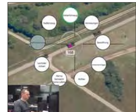
Abb. 4: Erkennungsassistentz mit KI-basierter Spracheingabe: Die um das Zielobjekt angeordneten Erkennungsmerkmale können mittels Sprachbefehlen für die Zielobjektbestimmung übernommen werden, ohne den Blick vom Zielobjekt abzuwenden
