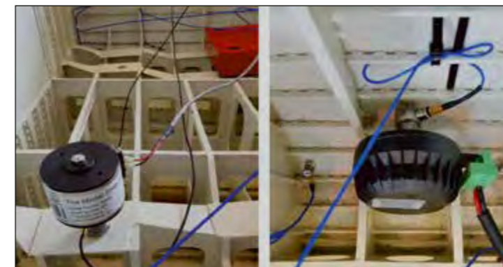
Abb. 4: Inertialschwingerregger im Schnellbootmodell zur Erzeugung der Ist-Signatur (links) und Inertialschwingerregger sowie Beschleunigungssensoren auf der Außenhaut zur Erzeugung der gewünschten Soll-Signatur (rechts)
