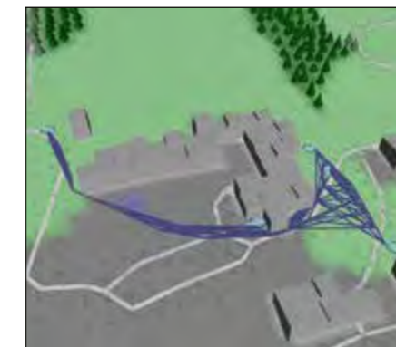
Abb. 4: Auf Basis eines Ausbreitungsmodells berechnete mögliche paarweise Funkverbindungen zwischen Punkten des Wegenetzes
