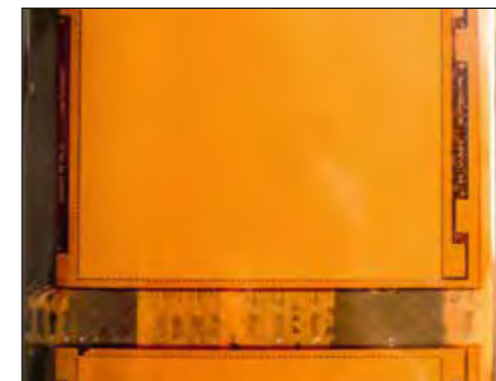
Abb. 3: Aktuator und Drucksensor-Vollschnitt eines verwindbaren Rotorblattes
