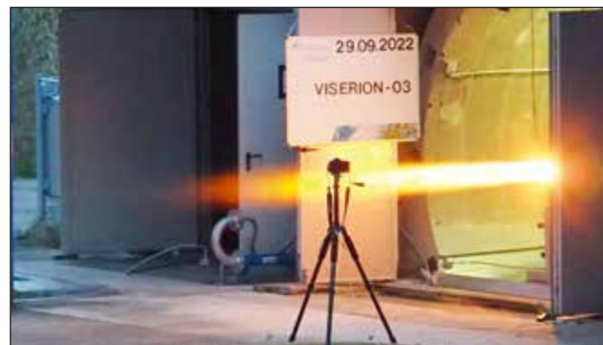
Abb. 2: Abgasstrahl des Motors im visuellen Spektrum
