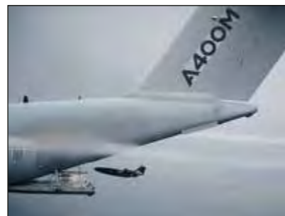
Abb. 1: Beispiel für das Absetzen eines Remote Carriers von einem militärischen Transportflugzeug. Gezeigt ist das Absetzen einer DT25 vom A400M, welches im Rahmen des von Airbus initiierten UAV Launcher Projektes durchgeführt wurde (Quelle: Airbus)
