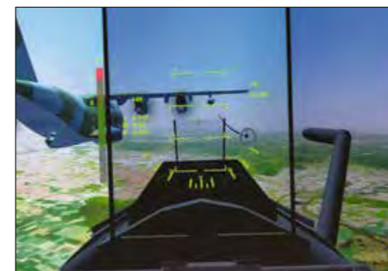
Abb. 3: Test eines Assistenzsystems für die Kampfflugzeug-Luftbetankung mit der Microsoft HoloLens
