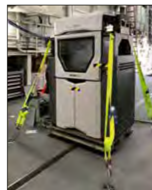
Abb. 2: CD&E Experiment Fregatte SACHSEN: Integration eines Level 2 MEX-Druckers
