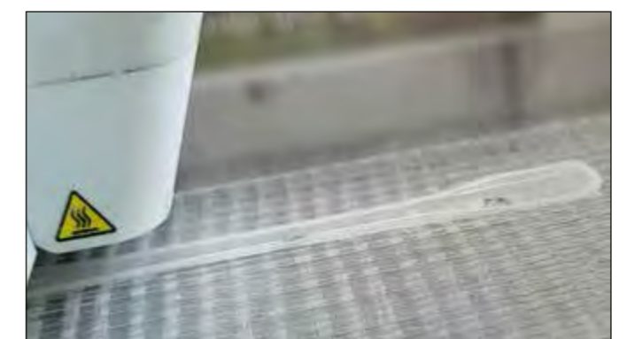
Abb. 4: Herstellung einer Zugprobe aus UHMWPE mittels FFF
