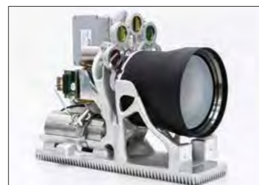
Abb. 2: ERNST-Hauptnutzlast: Spezialkamera mit Filterrad als Infrarot-Imager
