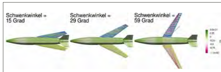
Abb. 2: Entwicklung der Strömung am RC in Abhängigkeit des Flügelschwenkwinkels für eine Machzahl von 0,85 und einem festen Anstellwinkel von 1^\circ . Die Abbildung zeigt die Oberflächendruckverteilung und die Wandschubspannungslinien
