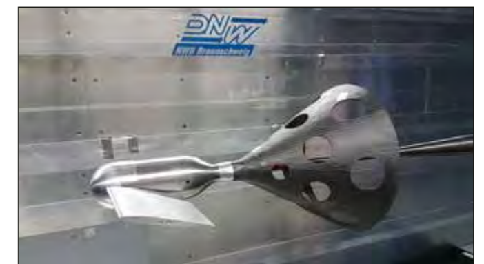
Abb. 4: Windkanalmessungen am skalierten, steuerbaren Betankungskorb
