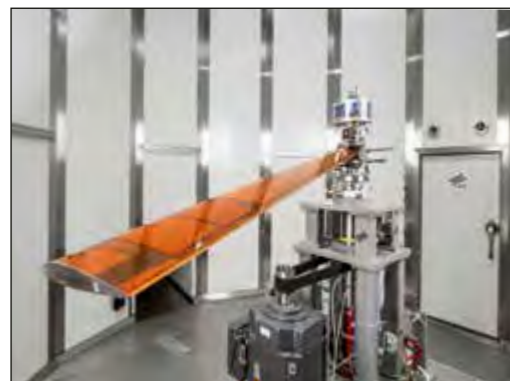
Abb. 1: Experimentelle Untersuchung eines verwindbaren Rotorblattes im Schleuderversuchsstand
