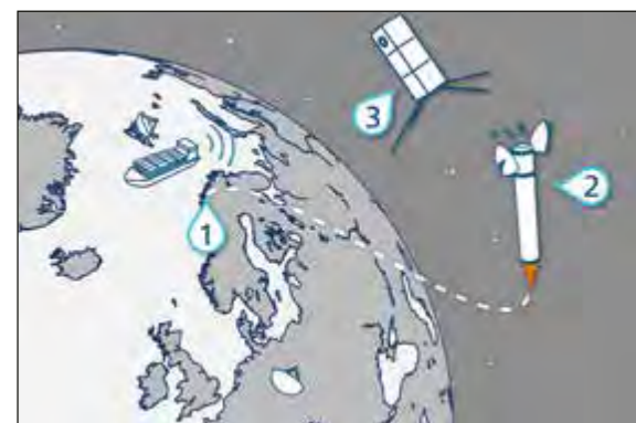
Abb. 1: Concept of Operations für OTTER: 1) Start mit ISAR Aerospace Spectrum Rocket aus Andøya, Norwegen 2) Separation im niedrigen, elliptischen Erdorbit 250 km bis 350 km 3) Aufnahme von AIS-Signalen und optischen Bildern von Schiffen
