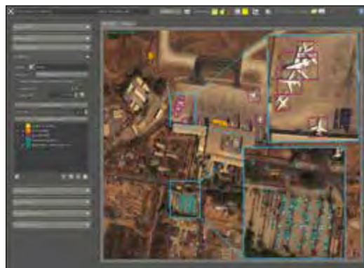
Abb. 1: KI-basierte Objektdetektion im Videoauswertesystem ABUL. Dargestellt sind Detektionen für die Klassen Flugzeug, PKW und LKW (Quelle Bildausschnitt: xView, vgl. Lam, Darius, et al. „xview: Objects in context in overhead imagery.“ arXiv preprint arXiv:1802.0785 (2018))
