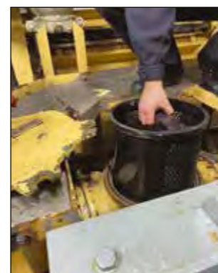
Abb. 3: Anwendungsfall eines additiv gefertigten Filtereinsatzes des Seekühlersystems auf Fregatte SACHSEN. Aufgrund der Größe nur mittels Level 2 3D-Druckern möglich
