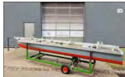
Abb. 2: Schnellbootmodell im Maßstab 1:8 mit einer Länge von ca. 6 m
