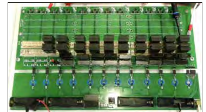
Abb. 4: Testboard zur Untersuchung von SiC-MOSFET-Schalter-Arrays, hier bestückt mit 40 SiC-MOSFETs in einer (10 x 4)-Anordnung
