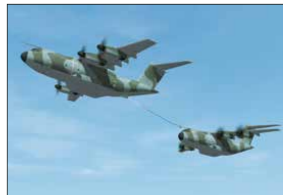
Abb. 1: Simulation einer Luftbetankung mit zwei FMTA (Future Military Transport Aircraft)
