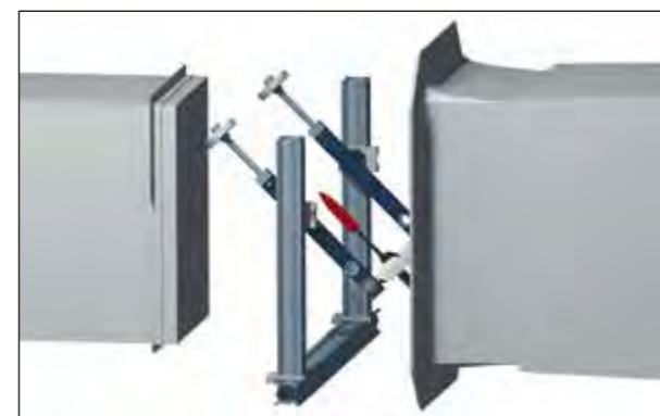
Abb. 2: CAD-Modell der Windkanal-Messstrecke mit Modellhalterung und montiertem Geschossmodell
