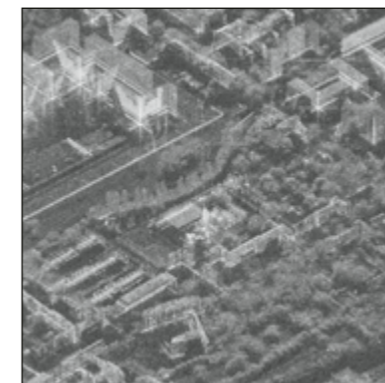
Abb. 4: SAR-Signatur (TerraSAR-X) eines Schornsteins, die aufgrund der SAR-spezifischen Aufnahmeeffekte kaum wahrzunehmen ist (Berlin, August 2017).
