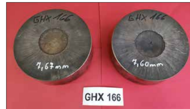
Abb. 3: Plate-Dent-Test zur Bestimmung der Beultiefe
