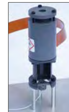
Abb. 4: Kombiniertes Versuchsaufbau zur Bestimmung von Detonationsdruck und Detonationsgeschwindigkeit
