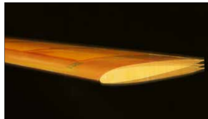
Abb. 2: Blattspitzenbewegung eines verwindbaren Rotorblattes
