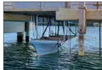
Abb. 3: Schnellbootmodell befestigt unterhalb der Messstelle der WTD 71 im Plöner See
