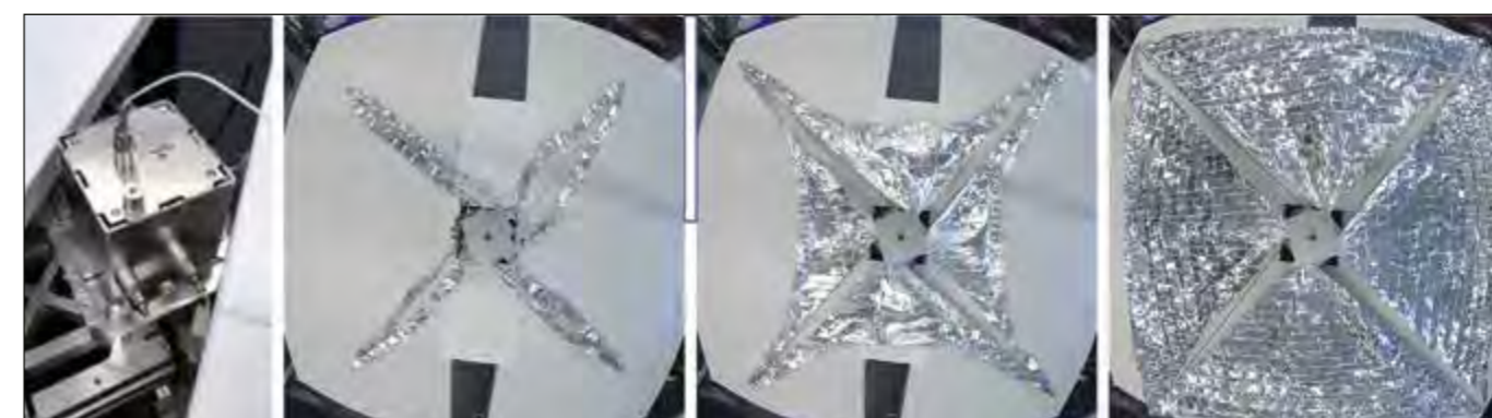
Abb. 3: ERNST-De-Orbit-Subsystem: Verstautes System (links) und Sequenz eines Entfaltungstests
