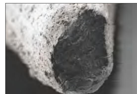
Abb. 3: Bruchfläche eines Filaments aus UHMWPE mit erhöhter Festigkeit (REM Aufnahme, Spannung 0.805 kV, Arbeitsabstand 2.1 mm)
