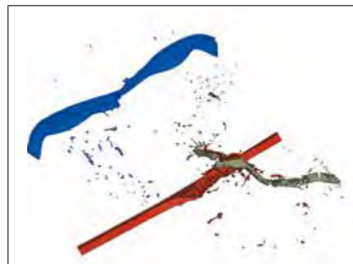
Abb. 2: Numerische Simulation einer ERA gegen ein APFSDS Projektil
