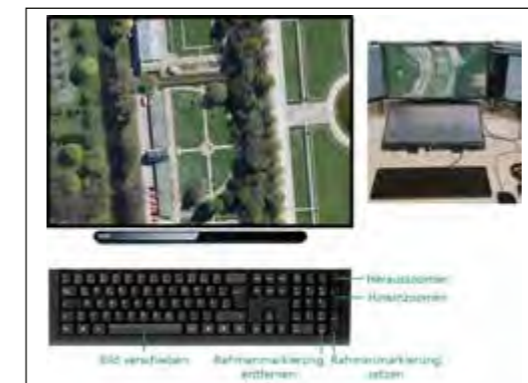
Abb. 3: Experimentalsystem mit dem Tobii 4C-Eyetracker unterhalb des Videoauswertemonitors. Die Zeigeoperation kann durch den Blick erfolgen und ermöglicht u. a. die Positionswahl relevanter Objekte (z. B. Fahrzeuge). Objektmarkierung, Bild zoomen und Bild verschieben werden an der Blickposition mittels verschiedener Tasten der Computertastatur ausgelöst
