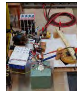
Abb. 4: Experimenteller Aufbau der Inverswandler-Topologie
