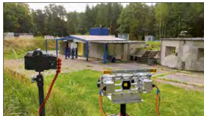
Abb. 1: Blick auf den Teststand mit den Kameras für das visuelle (links) und das infrarote Spektrum (rechts) im Vordergrund
