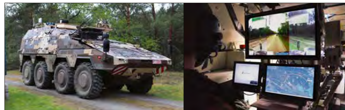
Abb. 1: Links: Joint Operational Demonstrator for Advanced Applications (JODAA). Rechts: Innenraumsicht mit den von Fraunhofer FKIE entwickelten Augmented Reality Overlays im Kamera-Monitor-System
