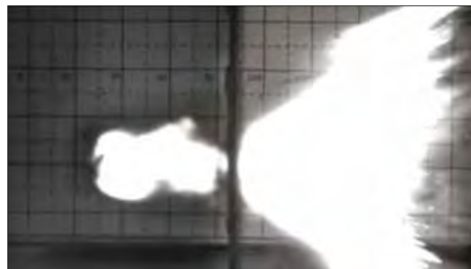
Abb. 1: Hochgeschwindigkeitsaufnahme vom Durchtritt eines Fragment-surrogats durch eine Platte aus Sicherheitsstahl von links nach rechts. Deutlich zu erkennen sind die Energiefreisetzung und die sich ausbreitenden Reaktionszone nach dem Zieldurchschlag
