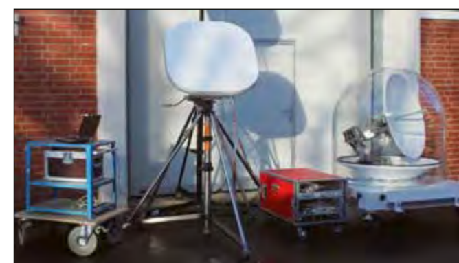
Abb. 2: Entwickelter Passivradar-Demonstrator SABBIA 2.0 mit kommerziellen Parabol- und Flachantennen
