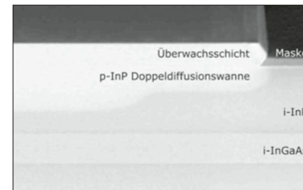
Abb. 3: Rasterelektronenmikroskop-Aufnahme eines im Querschnitt gespaltenen InGaAs/InP-Einzelphotonendetektors unmittelbar nach der zweiten Zinkdiffusion
