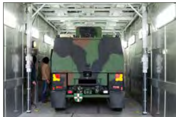
Abb. 1: Untersuchung des EAGLE V in der Klimakammer der WTD 41
