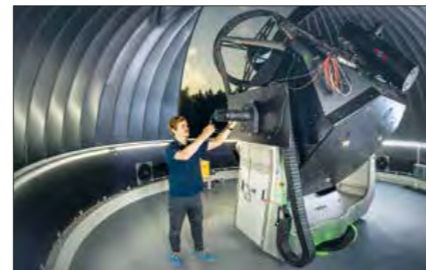
Abb. 3: Spiegelteleskop und Montierung im Kuppelraum des Johannes Kepler Observatoriums
