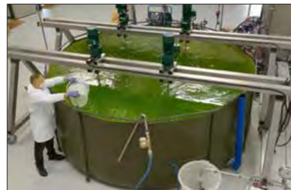
Abb. 2: Organisches Testwasser im Becken mit Rührwerk
