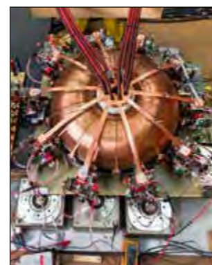
Abb. 3: Generator – induktiver Pulsstromgenerator für Schienenkanonen
