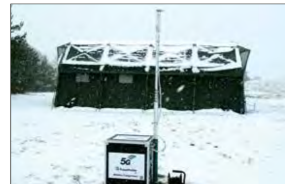
Abb. 3: Messaufbau zur Untersuchung des Einflusses eines Tragluftzeltes für Gefechtsstände auf die Kommunikation mit 5G
