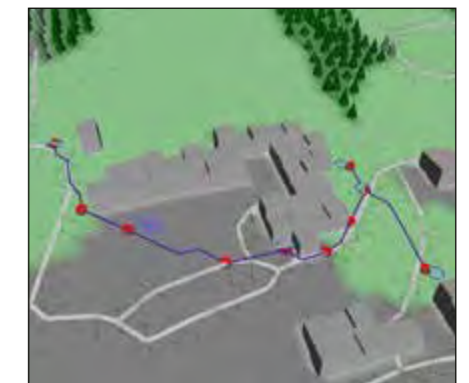
Abb. 5: Berechnete Positionen für die Relaisroboter
