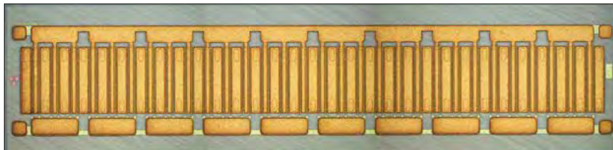
Abb. 1: Chipfoto eines 100 V-GaN-Transistors mit einer Ausgangsleistung von mehr als 400 W für Anwendungen im S-Band (2 bis 4 GHz)
