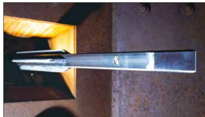
Abb. 2: Lanze für Blastdruckmessungen im streichenden Einfall
