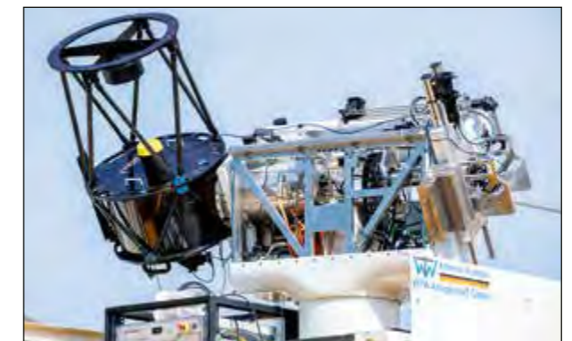
Abb. 4: Teleskopmontierung mit Empfangsteleskop (links) und Sendeteleskop (rechts) auf der Hubplattform der containerisierten Bodenstation (STAR-C: Surveillance, Tracking and Ranging Container)
