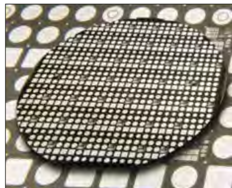
Abb. 1: 100 mm-Epi-Wafer samt SiC-Thyristor-Bauelementen mit unterschiedlichen Abmessungen
