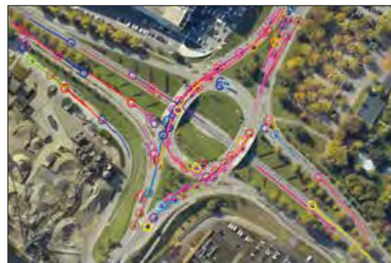
Abb. 2: KI-basiertes Multiobjekttracking in Wide Area Motion Imagery (WAMI). Dargestellt sind automatisch erkannte Trajektorien für bewegte Fahrzeuge (Quelle WAMI-Bildausschnitt: Hensoldt, vgl. Sommer, Lars, Wolfgang Krüger, and Michael Teutsch. „Appearance and motion based persistent multiple object tracking in wide area motion imagery.“ Proceedings of the IEEE/CVF International Conference on Computer Vision. 2021)
