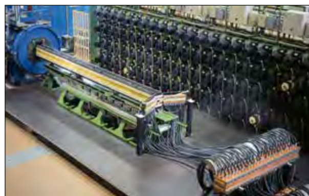
Abb. 2: Schienenkanone NGL 60 und kondensatorbasierte Versorgungsanlage PEGASUS
