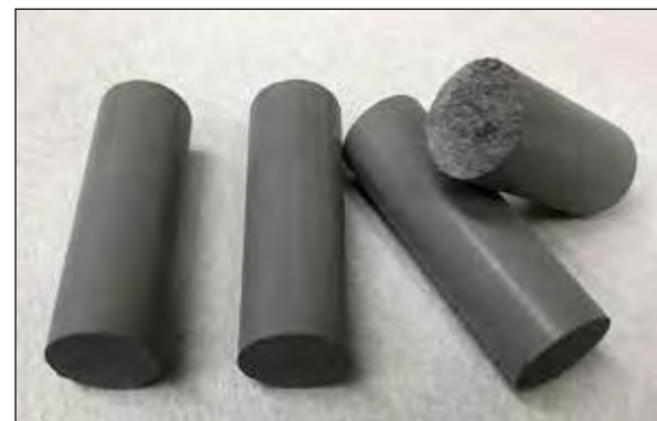
Abb. 1: Sprengladung, ausgearbeitete Formulierung für Unterwasseranwendungen
