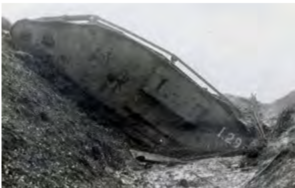
△ Abb. 286a: Ein in einem deutschen Panzergraben festgefahrener weiblicher Mark-Panzer. Beim Vorwärtsfahren gräbt sich die Schnauze des Panzers weiter ein. Für ein Zurücksetzen ist der Panzermotor zu schwach. (Quelle: SAMMLUNG WILLIG)
