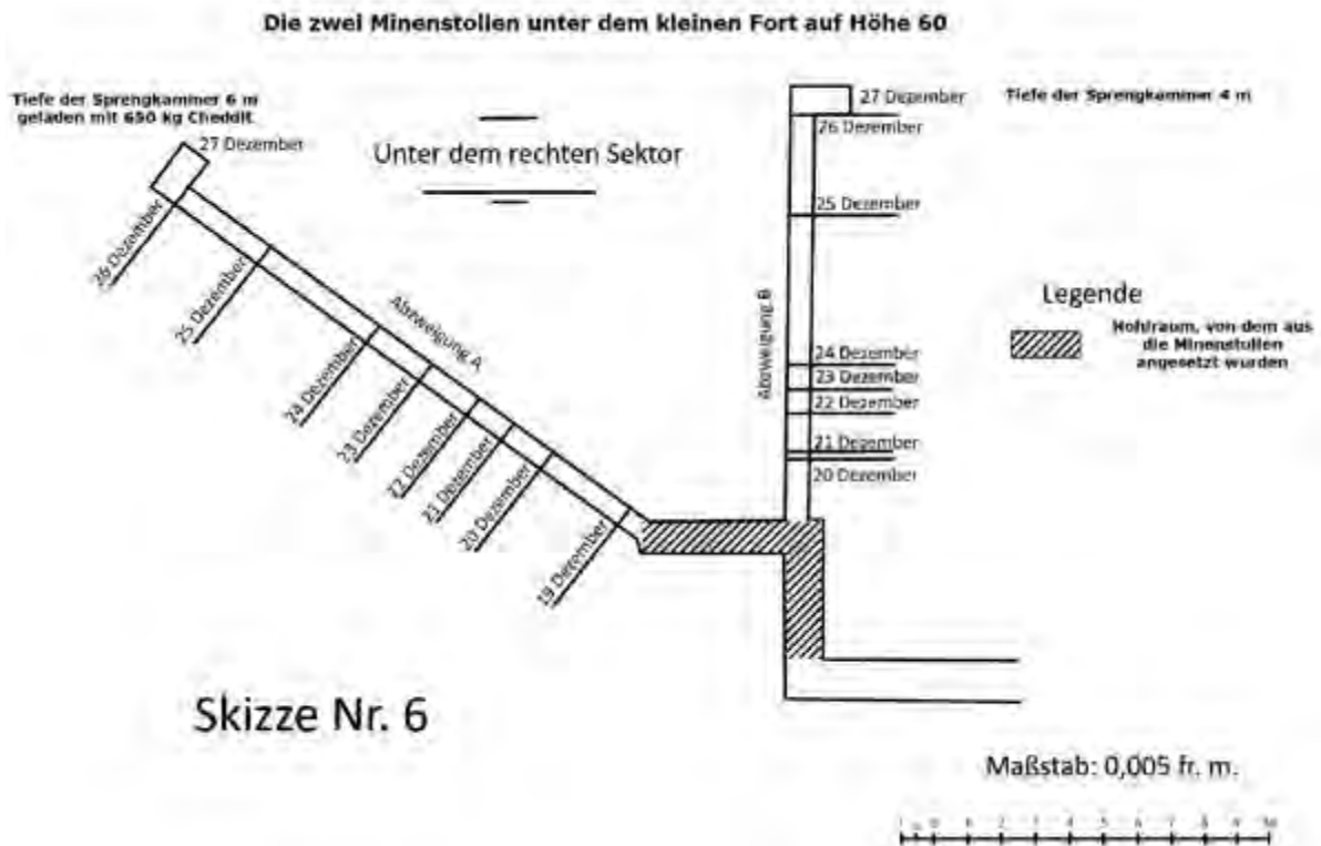
△ Abb. 68: Skizze der beiden Minengänge der französischen Sprengungen vom 29. Dezember 1914. Die Mineure der Kompanien 15/5 (7. Pionier-Regiment) und 6/3 (9. Pionier-Regiment) führten die Minierarbeiten durch. Die Minierarbeiten begannen etwa am 19. bzw. 20. Dezember 1914 und dauerten bis zum 27. Dezember 1914. Am 27. Dezember wurden die Sprengkammern ausgebaut und mit 650 und 380 Kilogramm Cheddite geladen und verdammt. Die Gesamtlänge der Stollen betrug 25 Meter. Der Vortrieb in den aufgeschütteten Tonen und Sanden betrug zwischen einem und vier Meter pro Tag. Die Sprengkammern befanden sich in sechs und vier Meter Tiefe m unter Geländeoberkante. Die Zündung erfolgte am frühen Nachmittag des 29. Dezembers 1914 und war der Quelle zu Folge ein voller Erfolg. (Quelle: Eigene Darstellung in Anlehnung an SERVICE HISTORIQUE DE LA DEFENSE, LAFORGERIE 2009)
