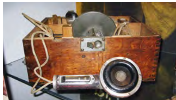
△ Abb. 197: Deutsches Hochgerät der Firma Waetzmann mit Hörer und Mikrofonplatte. (Quelle: WILLIG 2007)
