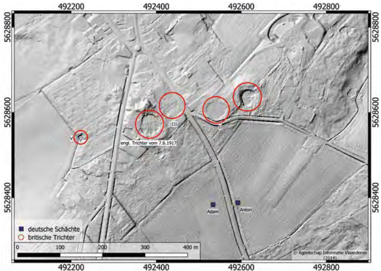
△ Abb. 29: Das digitale Oberflächenmodell des Bereichs vor St. Eloy zeigt, dass viele Trichter durch die anthropogene Überprägung u. a. durch die Landwirtschaft maskiert wurden. (Quelle: KRANZ 1935b, S. 174, DOM: AGENTSCHAP INFORMATIE VLAANDEREN (2014))
