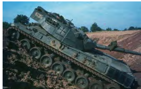
△ Abb. 286b: Ein Leopard 1 beim Überwinden eines soeben gesprengten Panzerabwehrgrabens. (Quelle: SAMMLUNG WILLIG)
