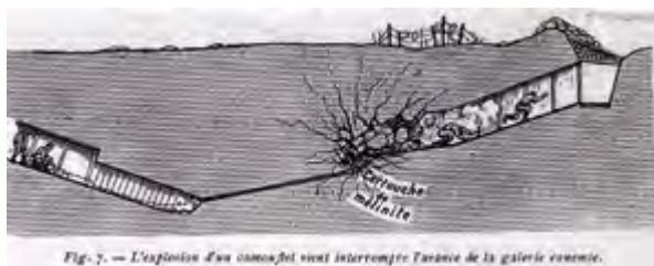
△ Abb. 177: Darstellung einer Bohrlochladung zum Abquetschen eines feindlichen Stollens. (Quelle: ANONYMUS 1916, Fig. 7)
