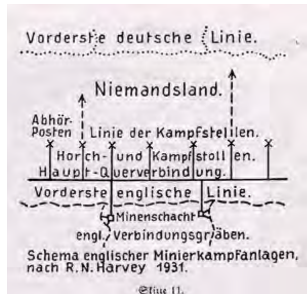
△ Abb. 190: Schema einer britischen Minierkampfanlage. (Quelle: KRANZ 1936a, Skizze 11)
