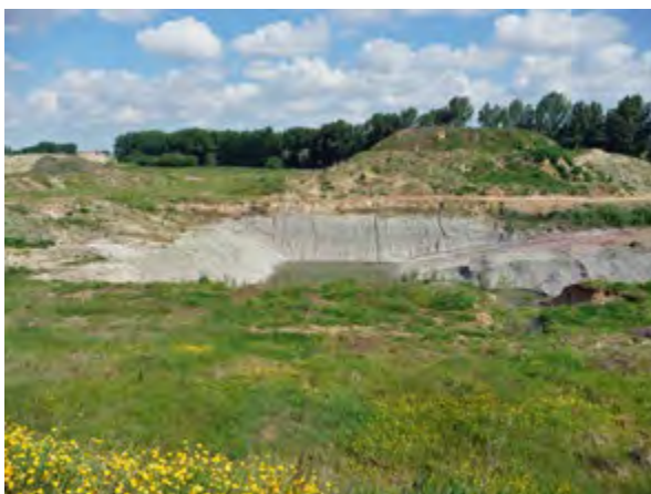
△ Abb. 138b : Übergangsbereich Ypern-Sand (gelbbraun) zum wasserstauenden Ypern-Ton (erdfeucht blaugrau, im Aufschluss grau) in der Tongrube Winterberger bei Zonnebeke. (Quelle: WILLIG 2009)
