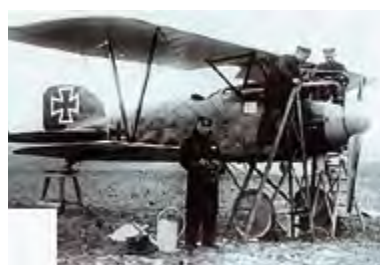
△ Abb. 264: Albatros D1 – Bordmechaniker arbeiten am Motor. Vor dem Flieger steht der Beobachter mit einer Luftbild-Handkamera. (Quelle: SAMMLUNG WILLIG).
