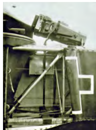
△ Abb. 267: Luftbildkamera, die im Flugzeugrumpf fest eingebaut wurde. (Quelle: Archiv des Ausbildungszentrums für abbildende Aufklärung der Luftwaffe [AZAALw] in Fürstentfeldbruck)
