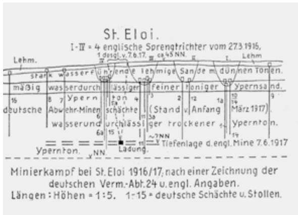
△ Abb. 217: Profil durch die Sprengungen vom 27. März 1916 und die aus den 10 bis 15 Meter tiefen Trichtern (Trichter I.-IV.) abgeteufte Schächte und von denen aus Angriffstollen im Ypern-Ton vorgetrieben wurden. Diese Trichter wurden auch mit Unterständen und ‚sanitären Anlagen‘ versehen (vgl. auch Abb. 218 ). (Quelle: KRANZ 1935b, S. 7, Abb. 10 )
