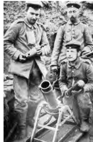
△ Abb. 140: Lanz Minenwerfer mit Bedienungsmannschaft der Pioniere. Dieser Werfer diente zur Bekämpfung naheliegender Schützengräben im Steilfeuer. (Quelle: ORGELDINGER 1931, S. 54)
