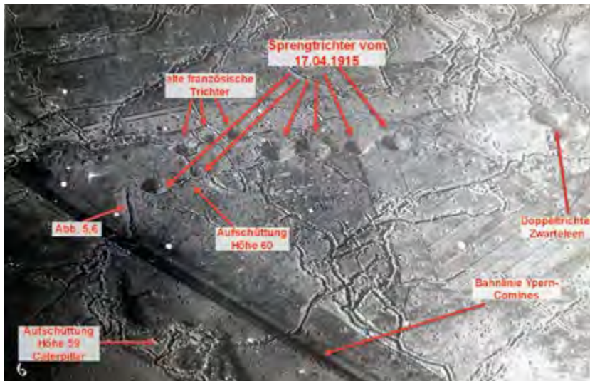
◁ Abb. 76: Luftbild des Bereiches Eisenbahnhöhe 59/60 bis zum Doppeltrichter Zwarteleen. Links unten ist die Aufschüttung Höhe 59 zu erkennen. In diesem Bereich entstand am 7. Juni 1917 der Trichter Caterpillar. In der linken Bildmitte ist der Schützengraben in der Eisenbahnböschung zur Höhe 60 ( Abb. 71, 72 ) zu erkennen. Drei französische kleine Sprengtrichter und die sechs Sprengtrichter vom 17. April 1915 sind mit Pfeilen versehen. (Quelle: SAMMLUNG WILLIG)
