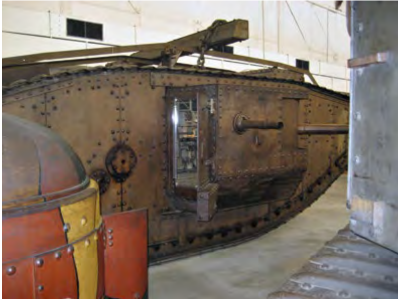
△ Abb. 282a: Männlicher Mark-Panzer, in der Version Mark IV. Rechte Waffenkanzel mit nach vorne zeigender 57-Millimeter-Kanone und Maschinengewehr. Die rechte geöffnete Klappe zeigt die relativ dünne Panzerung. Die Klappe diente auch zum Ausbooten. Oben auf dem Panzer erkennt man den mitgeführten Balken, der beim Überwinden von Gräben eingesetzt wurde. (Foto aufgenommen im Royal Military Museum Brüssel: WILLIG)
