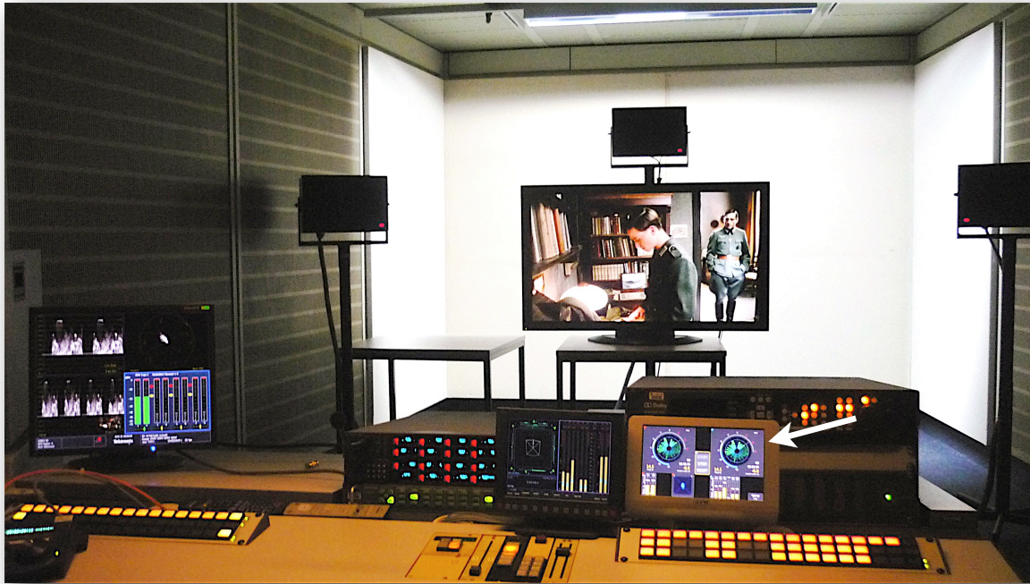
Abbildung 7: Ein Tonstudio für die technische Sendeband-Abnahme beim ZDF in Mainz. Sichtbar ist der erhöhte Abstand der Frontlautsprecher zur Abhörposition und das in allen Studios des ZDF verwendete Messgerät von RTW für die Messung nach EBU R128.
