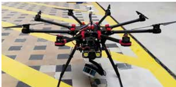
Abbildung 1: Inspektionsdrohne mit Lidar und Kamera
