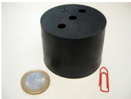
Abbildung 2: Für die Untersuchung ausgewähltes dickwandiges Bauteil (Zylinder mit  $h = 40 \text{ mm}$ ,  $\varnothing = 55 \text{ mm}$ ); die Sicht erfolgt hier auf die Unterseite des Zylinders mit den aufgrund der Thermoelemente entstandenden Löchern.
