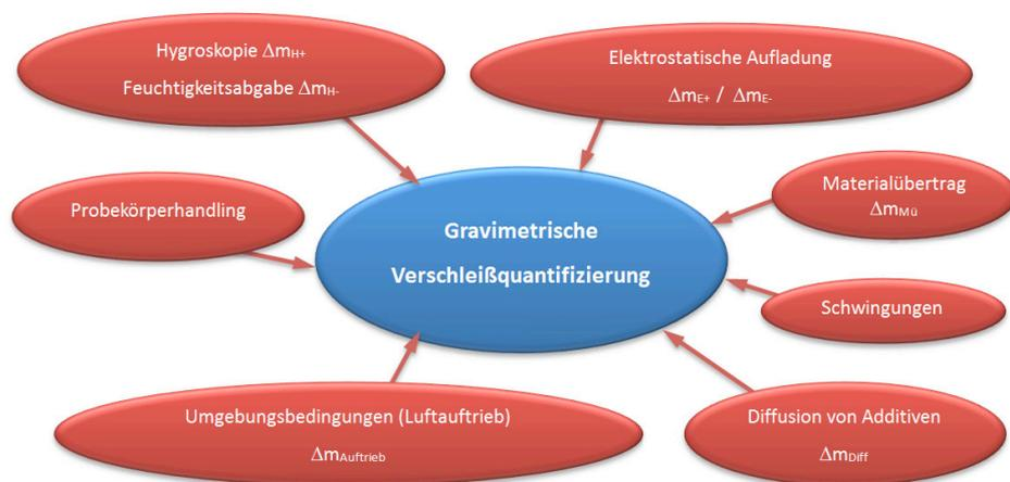
Abbildung 3: Einflussfaktoren/Störgrößen bei der gravimetrischen Verschleißquantifizierung
