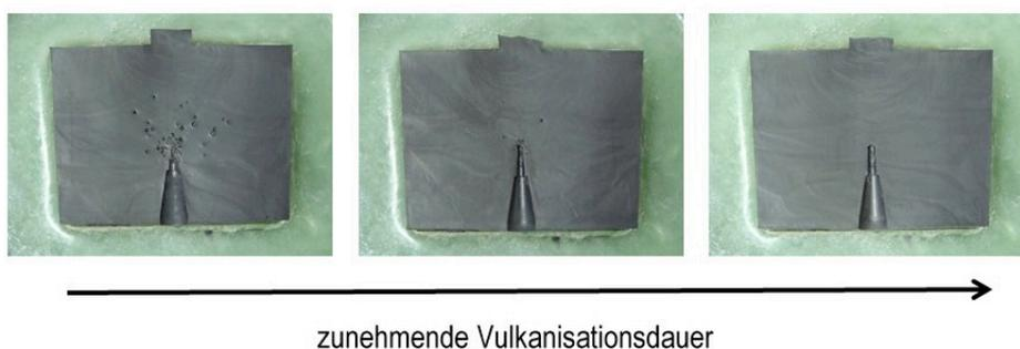
*Abbildung 5: In der Mitte aufgeschnittene Zylinder mit unterschiedlichen Heizzeiten. Von links nach rechts nimmt die Heizzeit zu. Deutlich sind in den untervulkanisierten Bereichen Blasen zu erkennen. In der Mitte des Zylinders entsteht eine Aussparung durch das Thermolement, in welcher sich bei der Dichtemessung Luftblasen der gleichen Größenordnung der Blasen im Bauteil ansammeln.*
