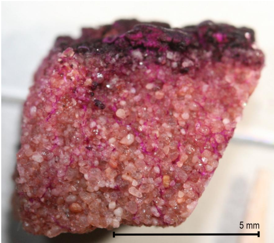
Abb. 20: Die bläulich-rot eingefärbten Flechtenhyphen sind als dünne lila Fäden, deutlich erkennbar, im gesamten Probekörper verteilt. Quelle: D. Ohnmeiß
