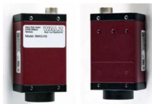
Abb. 32: Kamera des IMAGING-PAM-MINI
