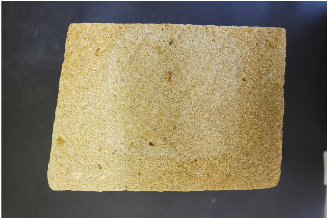
Abb. 23: Beschichtungsprobe mit Titandioxid, in der Mitte des Steins ist das 10x10 cm beschichtete Feld zu erkennen. Quelle: D. Ohnmeiß
