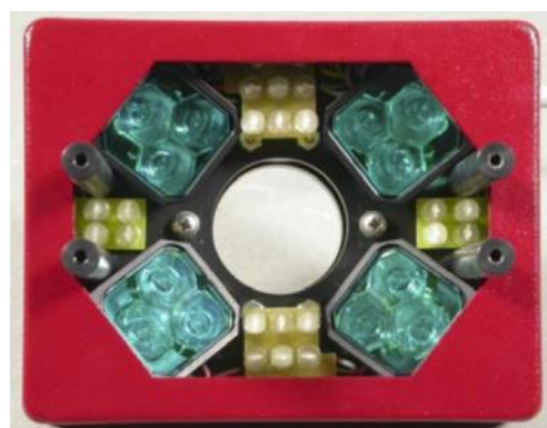
Abb. 31: LED-Array des IMAGING PAM MINI
