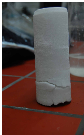
Abbildung 36: links: Bohrkern nach 10 Salzsprengtestzyklen, rechts Bohrkern nach 10 Salzsprengtestzyklen und sechsständiger Lagerung in 2cm hoher gesättigter Salzlösung (beide Kerne sind 12cm hoch und 4,9 cm breit; Skala in km/s).
