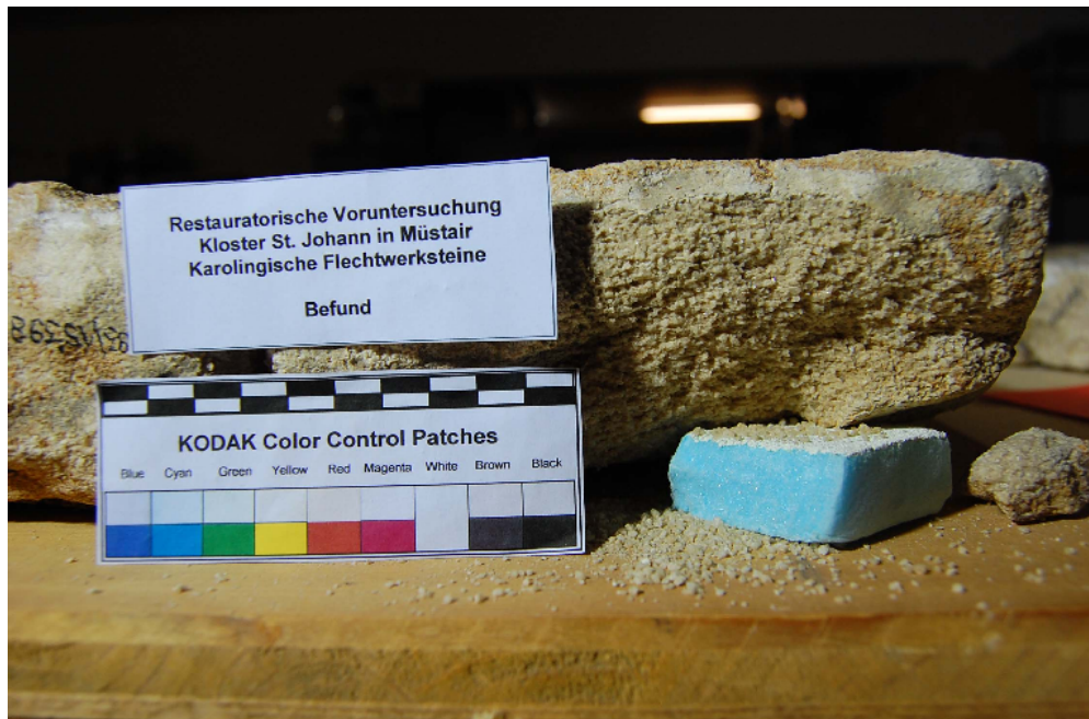
Abbildung 18: Mo 1b (Inventarnummer: M93/15'398). Das Lockermaterial wurde für die Ionenchromatographie verwendet. Das Fragment ist an vielen Bereichen sehr stark abgrusend.
