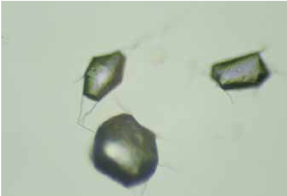
Abbildung 21: Rückstand nach dem Auflösen des Partikels in Salzsäure, vermutlich ölige Bestandteile einer früheren Maßnahme (Probe P06, Objektiv: 20er; Bildbreite 440µm).
