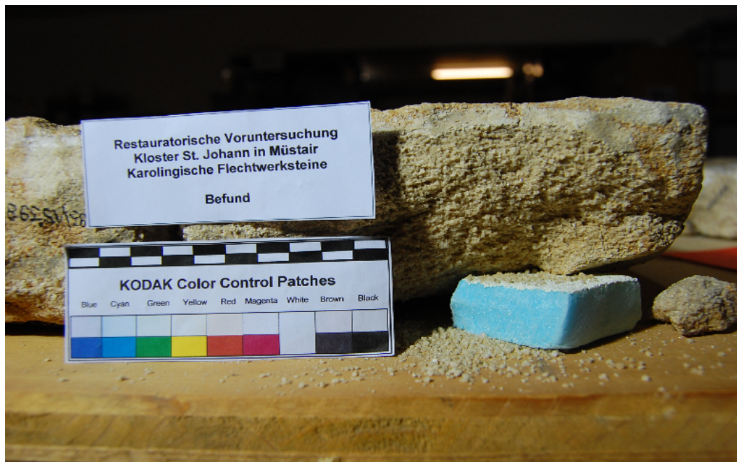
Abbildung 13: Abgrusender Bereich, bereits bis zu 6 cm sind von der Oberfläche zurückgewittert. Der Gesteinsverlust geschieht hier in hohem Tempo, wobei sich ganze Körner aus dem Gefüge herauslösen.
