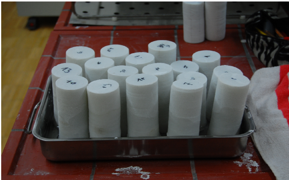
Abbildung 35: Bohrkerne in Salzlösung, die Salzlösung ist bis in eine Höhe von 12 cm in das Gestein eingedrungen.
