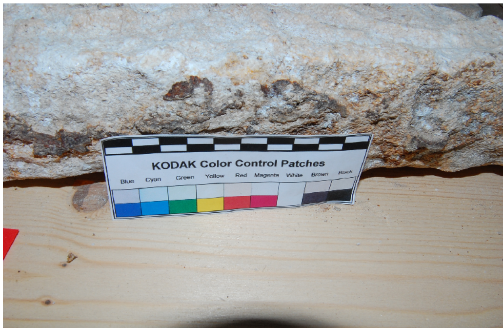
Abbildung 13: Abgrusender Bereich, bereits bis zu 6 cm sind von der Oberfläche zurückgewittert. Der Gesteinsverlust geschieht hier in hohem Tempo, wobei sich ganze Körner aus dem Gefüge herauslösen.
