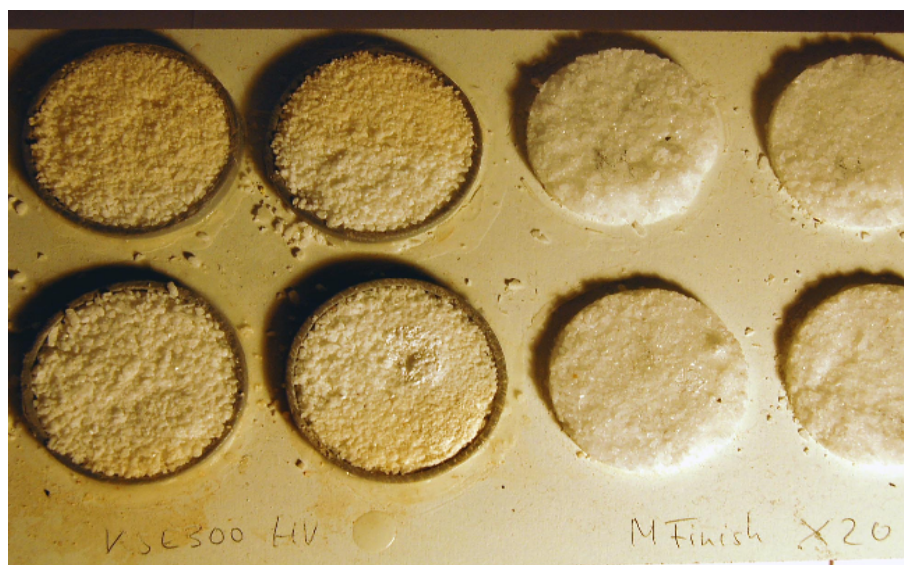
Abbildung 32: Ringe aus Lockermaterial 3 Wochen nach dem Tropfentest: obere Reihe unversalzen, untere Reihe mit zugegebenem Natriumsulfat, links mit KSE 300 HV mit leichter Verbräunung in einigen Bereichen, sowie Effloreszenzen, rechts mit M Finish X 20 mit starker Glanzbildung und kleinen Effloreszenzen.
