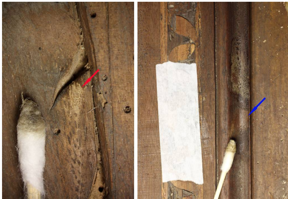
Abb. 29, Abnahmeversuch der Oberflächen- überzüge auf den holzsichtigen Teilen – Abnahme mit Wasser des nicht fluoreszierenden Überzuges (rot), Abnahme des Firnisses mit Aceton (blau)
