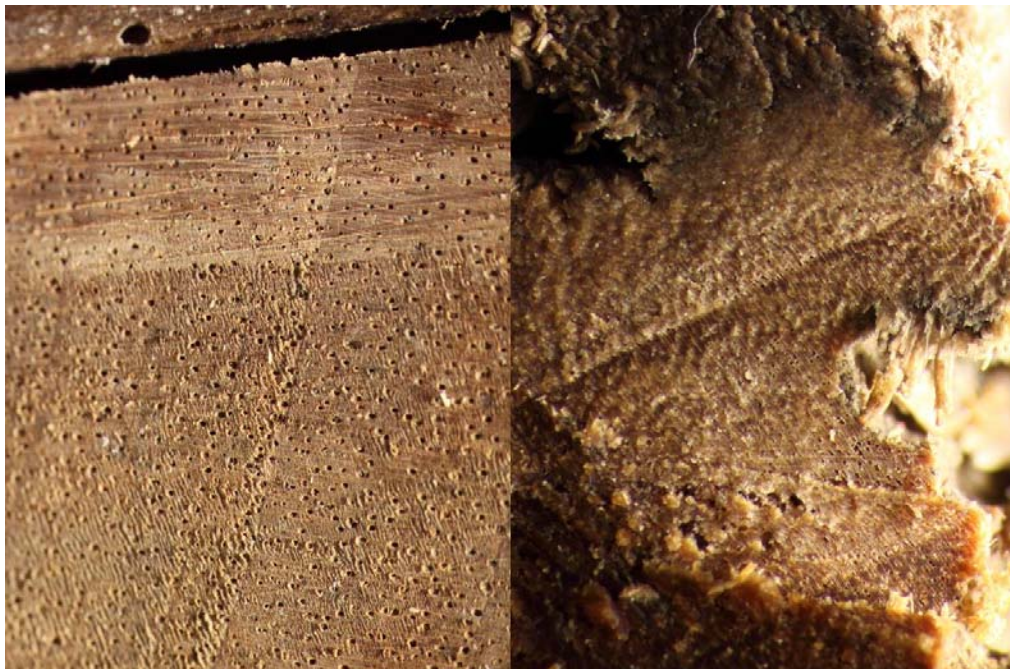
Abb. 21, Querschnitt der bauzeitlichen Holzarten – links Pappel, rechts Nussbaum
