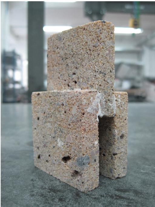
Abb. 16: Prüfkörper aus Naga-Sandstein für den Schubversuch
