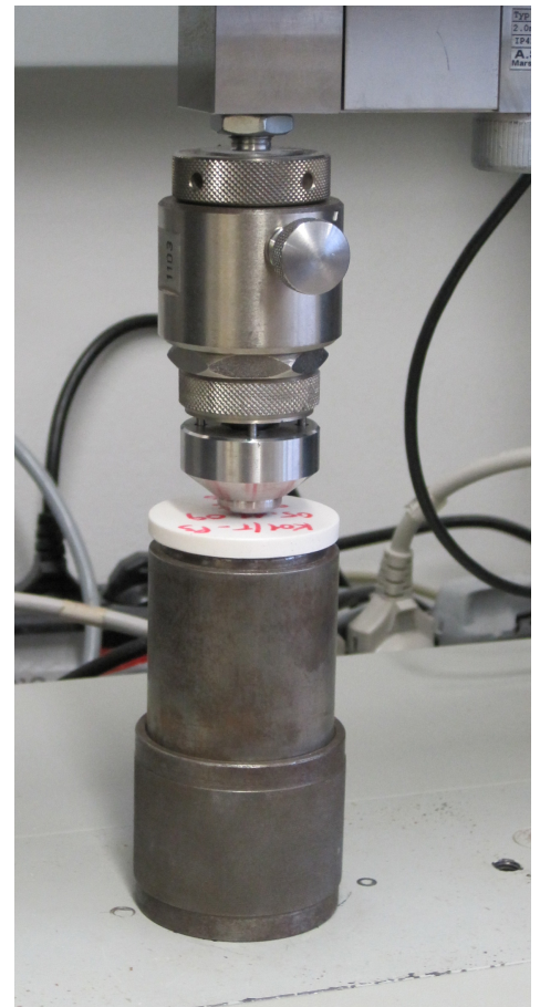
Abb. A09: Probekörperaufnahme für die biaxiale Biegezugprüfung
