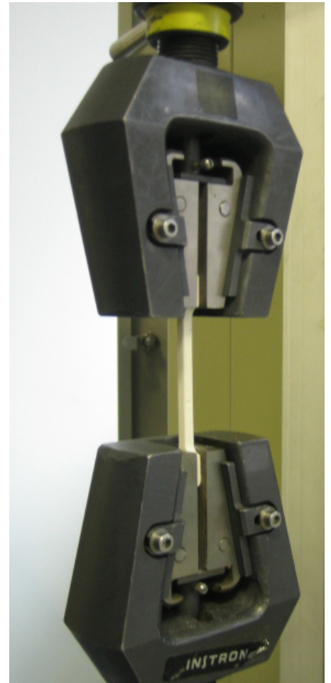
Abb. A12: Probekörperaufnahme für die Messung der Zugfestigkeit
