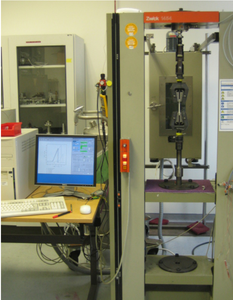
Abb. A11: Prüfvorrichtung zur Messung der Zugfestigkeit an der BAM (Typ: ZWICK ROELL 1454)
