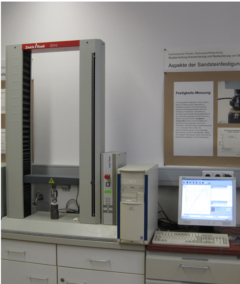
Abb. A08: Prüfvorrichtung zur Messung der biaxialen Biegezugfestigkeit an der FH POTSDAM (Typ: ZWICK ROELL Z010)
