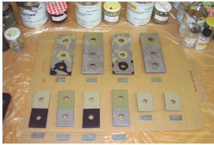
Abb. 48 Auftrag der Deckschichten auf die Probplatten. 260
