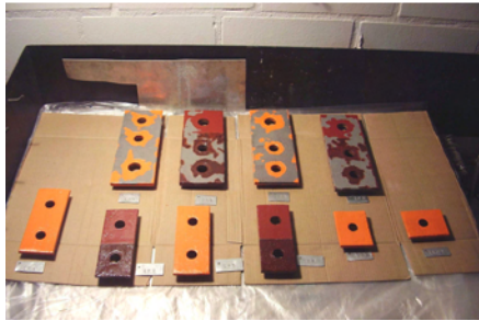
Abb. 47 Auftrag der jeweiligen Grundbeschichtung auf die Probeplatten. 254
