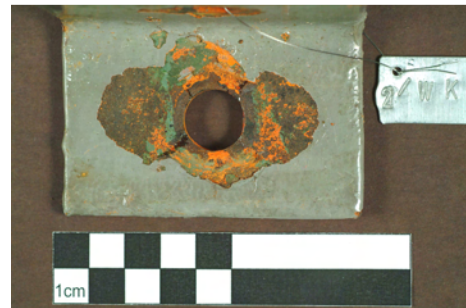
Abb. 38 Detailansicht eines kleinen Winkелеlementes (WK2-V1) nach dem Abreißen der Stempel. Adhäsionsbruch zwischen Substrat bzw. dessen Korrosionsprodukten und angrenzenden Schichten (A/ B, A/ C).
