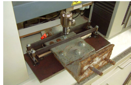
Abb. 36 Haftfestigkeitsmessungen bei Traufanker R1. Vor dem Abreißen des 3. Stempels. 180
