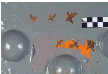
Abb. 41 Kreuzschnittprüfung auf dem Traufanker GR8. Untere Bildhälfte: Felder 1 bis 4 von links nach rechts; obere Hälfte: Kompressen-Test in gleicher Anordnung der Prüffelder. 201
