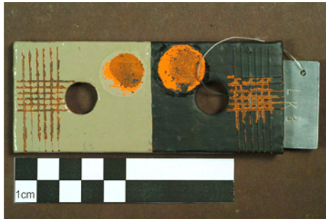
Abb. 54 Unbewitterte Probeplatte LK3 nach den Haftzugfestigkeitsmessungen und den Gitterschnittprüfungen. 274
