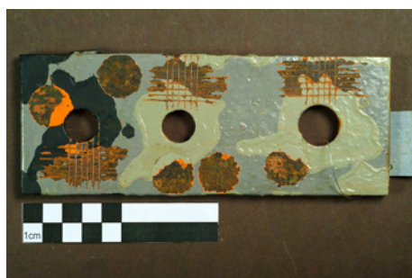
Abb. 56 Bewitterte Probeplatte LG1 nach den Haftzugfestigkeitsmessungen und den Gitterschnittprüfungen.
