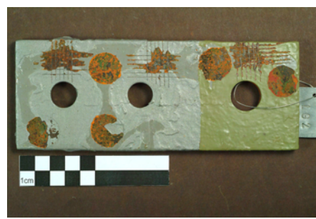
Abb. 57 Unbewitterte Probeplatte LG2 nach den Haftzugfestigkeitsmessungen und den Gitterschnittprüfungen.
