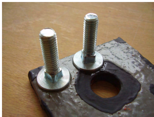
Abb. 53 Aufkleben der Prüfstempel im Bereich der optisch intakten historischen Oberfläche, direkt neben dem Grenzflächenbereich (li) und auf dem Grenzflächenbereich (re.)
