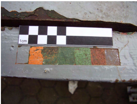
Abb. 8 Farbtreppe auf Binder 5. Schichtaufbau von links nach rechts: grau, orange, grün-schwarz, dunkelgrün, grün, rot-braun, Substrat. 72
