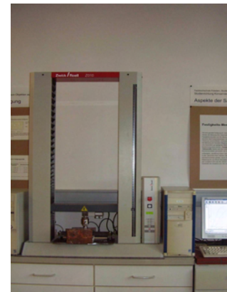
Abb. 35 Gerät zur Messung der Haftzugfestigkeit.
