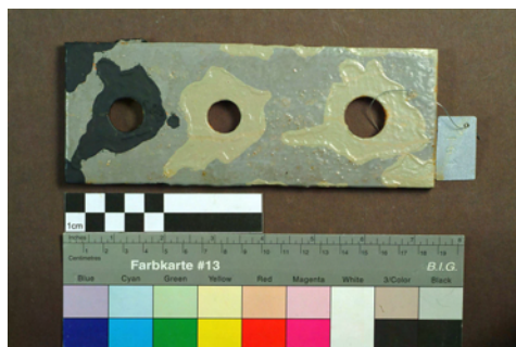
Abb. 51 Probeplatte LG1 nach der künstlichen Bewitterung. 264
