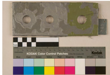
Abb. 49 Auftrag Ausfleckerarbeiten auf der Probplatte LG4 mit System 3 (li.), System 4a (mi.) und System 4 (re.) 261
