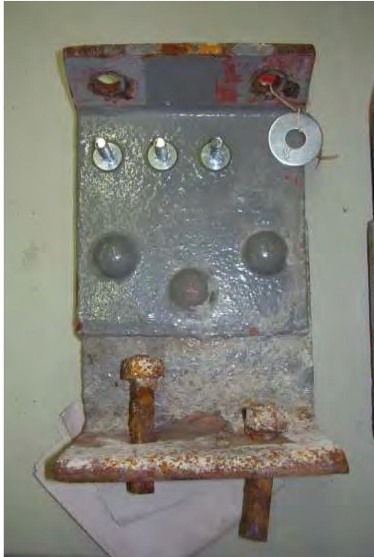
**Bild 54** Für die Haftzugfestigkeitsmessungen werden je Traufanker drei Prüfstempel auf die optisch intakte, relativ ebene Beschichtung aufgeklebt. Hier ist Traufanker R4 zu sehen.
