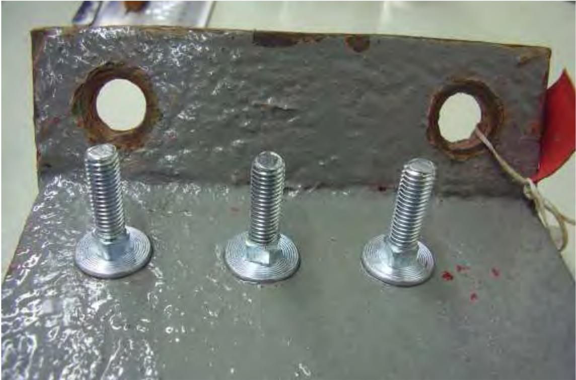
**Bild 55** Detailansicht der für die Haftzugfestigkeitsmessungen aufgeklebten Stempel auf einem Traufanker.
