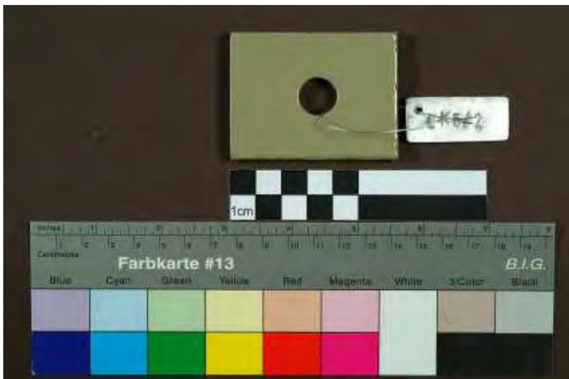
**Bild 96** Neubeschichtung der Probeplatte LK5-2 mit Öl-Bleimennige und Alkyddecklack (System 2a: dreifacher Decklack-Auftrag).
