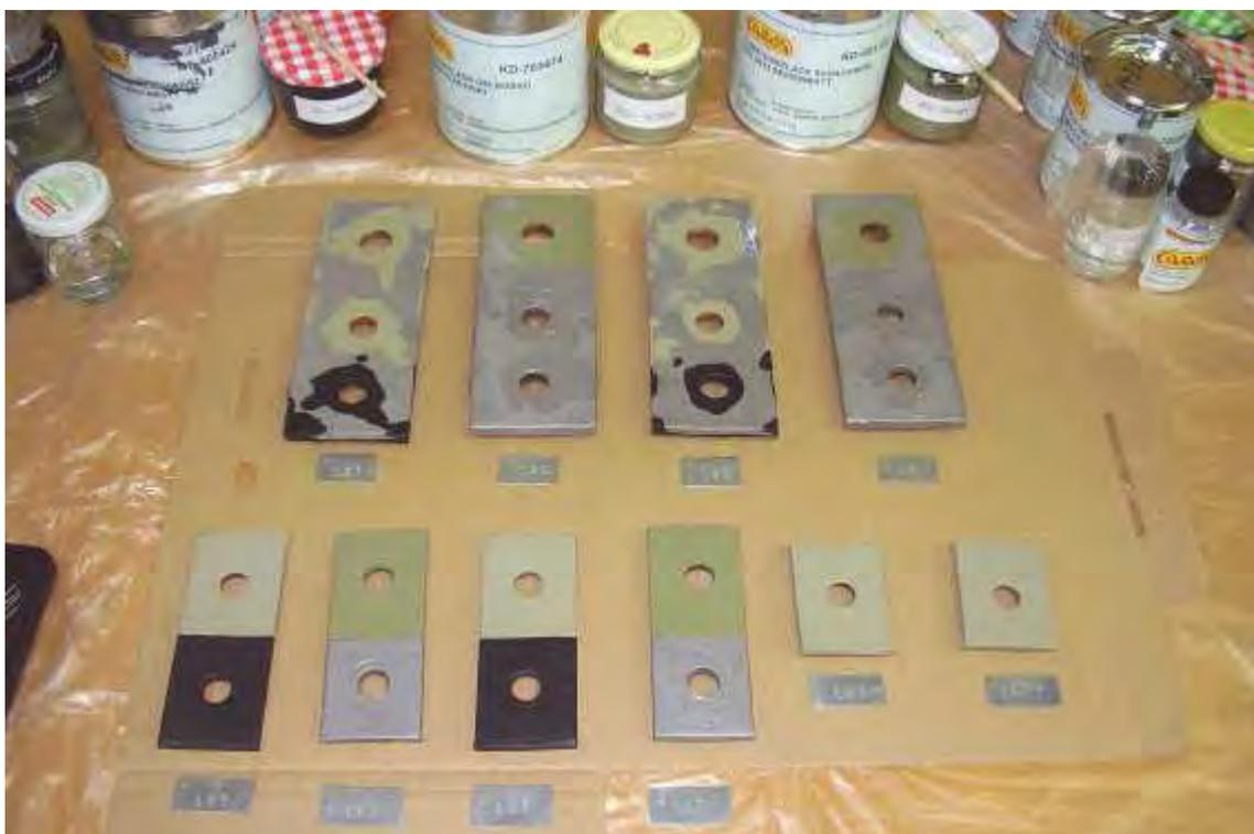
Bild 90 (Abb. 48) Auftrag der jeweils 1. Deckschicht auf die Probeplatten.
