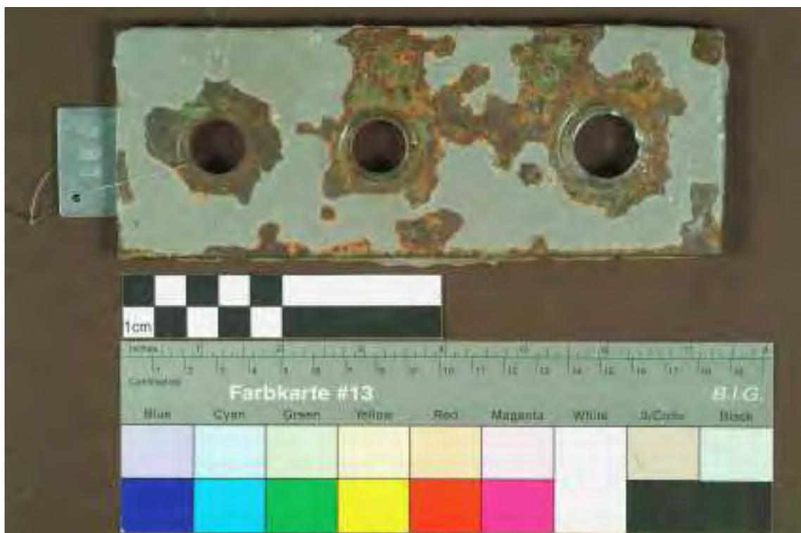
Bild 88 Große Lasche LG4 nach der partiellen Oberflächenvorbereitung.
