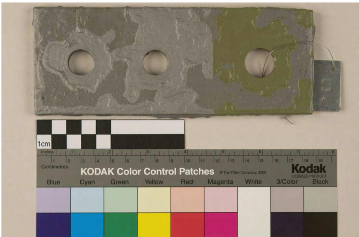
**Bild 100** (Abb. 49) Ausfleckungsarbeiten auf der Probeplatte LG4 mit System 3 (links: EK-PUR-System), System 4a (mitte: EK-PUR-System) und System 4 (rechts: Zinkphosphatgrundierung und Alkydharz).
