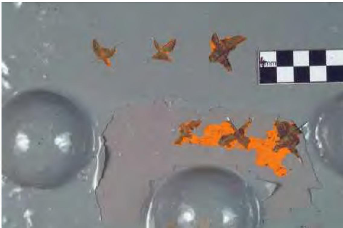
**Bild 73** (Abb. 41) Detailansicht der Kreuzschnitte auf Traufanker GR5 mit nun ersichtlichem 8-schichtigem Aufbau nach dem Kompressen-Test. Untere Bildhälfte: Felder 1 bis 4 von links nach rechts, obere Hälfte: Kompressen-Test in gleicher Anordnung der Prüffelder.
