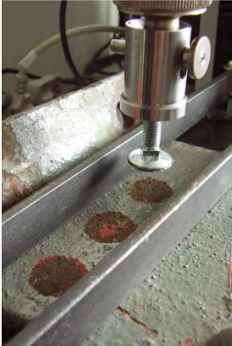
**Bild 59** Haftzugfestigkeitsmessungen der Beschichtung des Traufankers R1. Nach dem Abreißen des 3. Stempels, Detailansicht.
