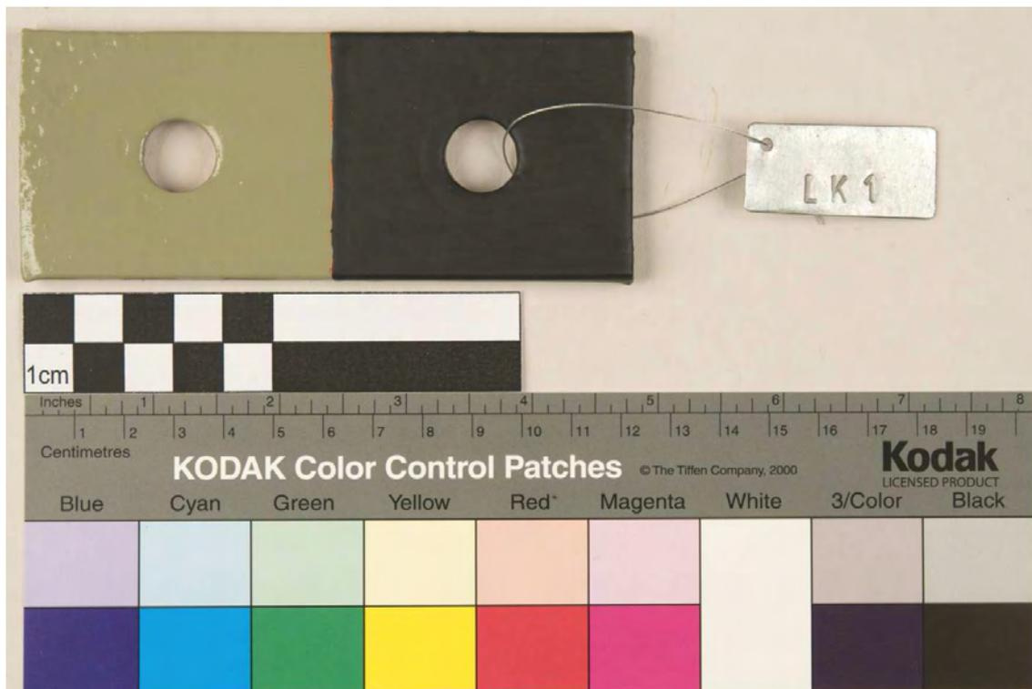
**Bild 91** Neubeschichtung der Probeplatte LK1 mit Öl-Bleimennige und Alkyddecklack (li. System 2), sowie mit Öl-Bleimennige und Öllack (re. System 1).
