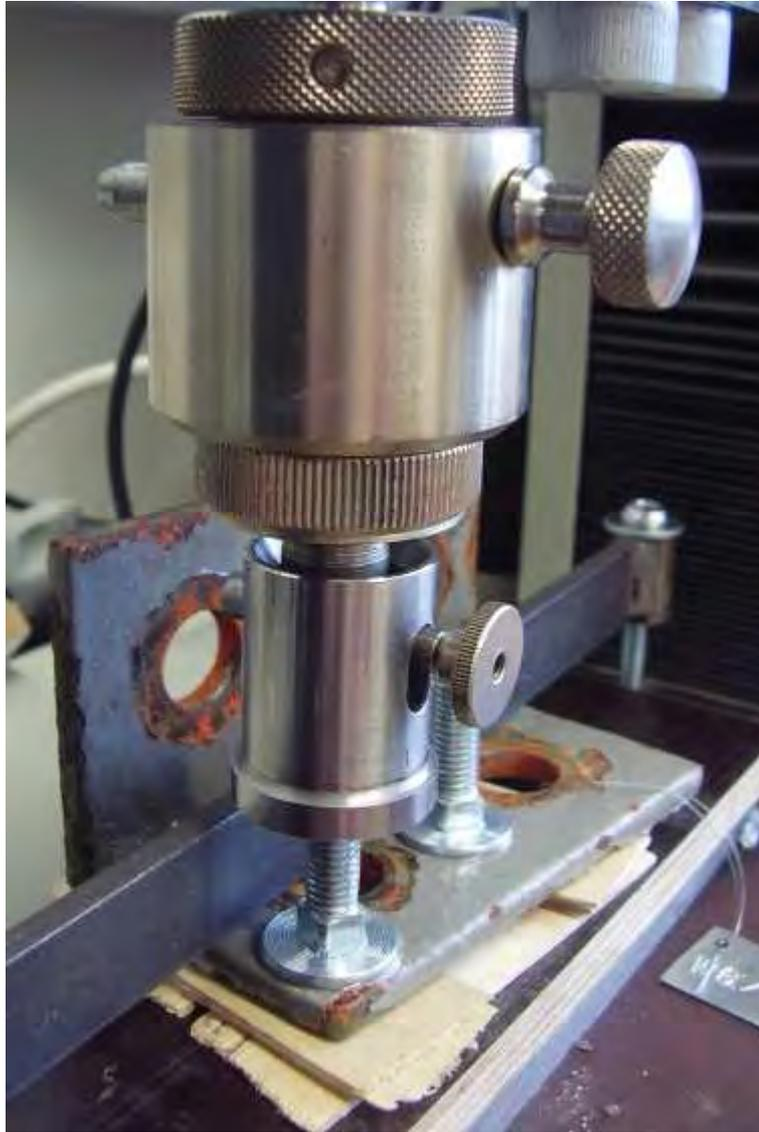
**Bild 60** Haftzugfestigkeitsmessungen im Grenzflächenbereich, bei einem großen Winklelement (WG2-V1). Vor dem Abriss des 1. Prüfstempels.
