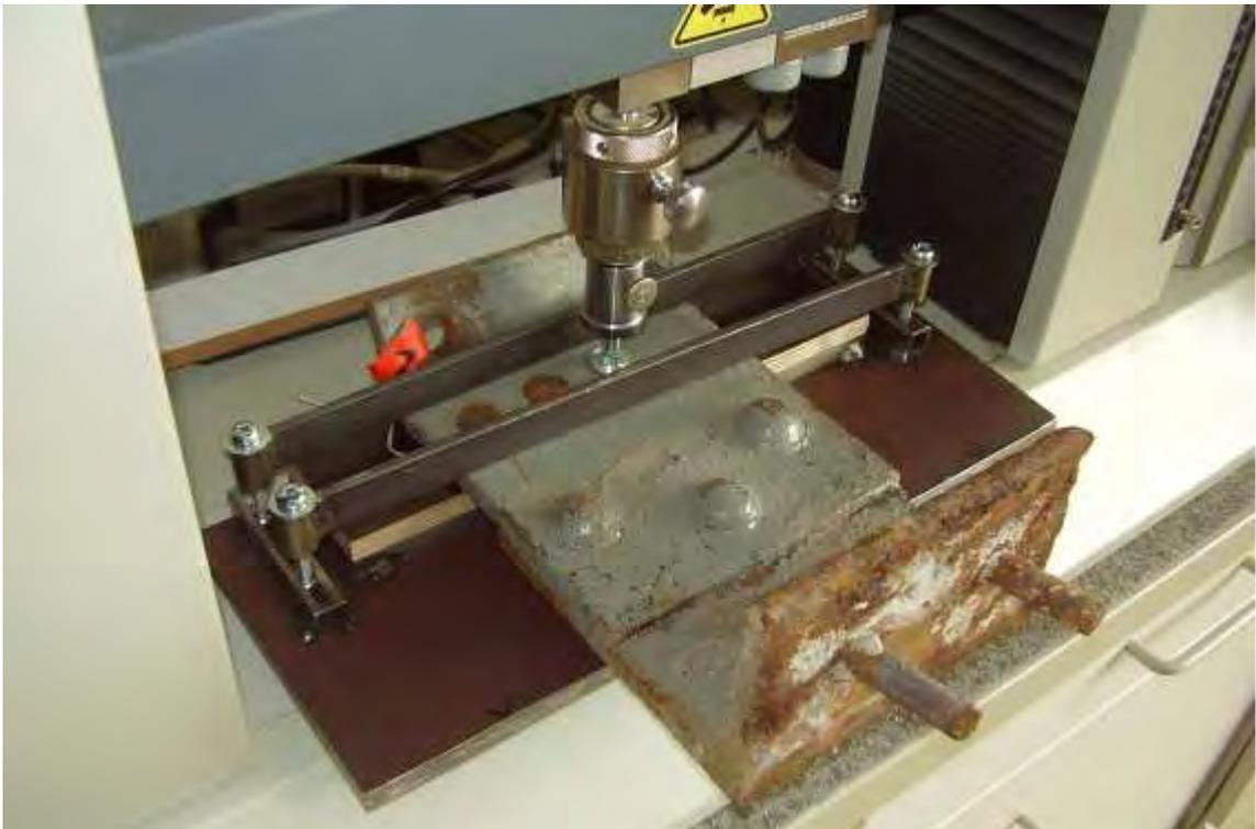
**Bild 58** (Abb. 36) Haftzugfestigkeitsmessungen der Beschichtung des Traufankers R1. Vor dem Abreißen des 3. Stempels.
