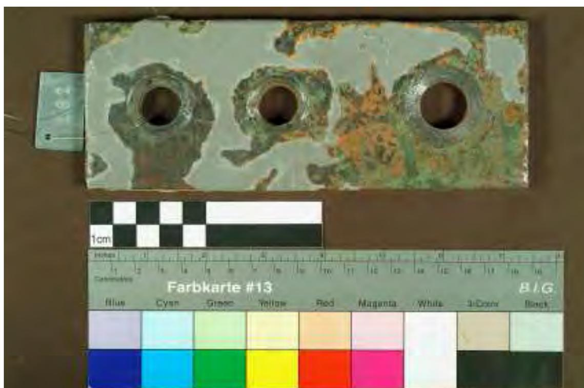
Bild 86 (Abb. 46) Große Lasche LG2 nach der partiellen Oberflächenvorbereitung.
