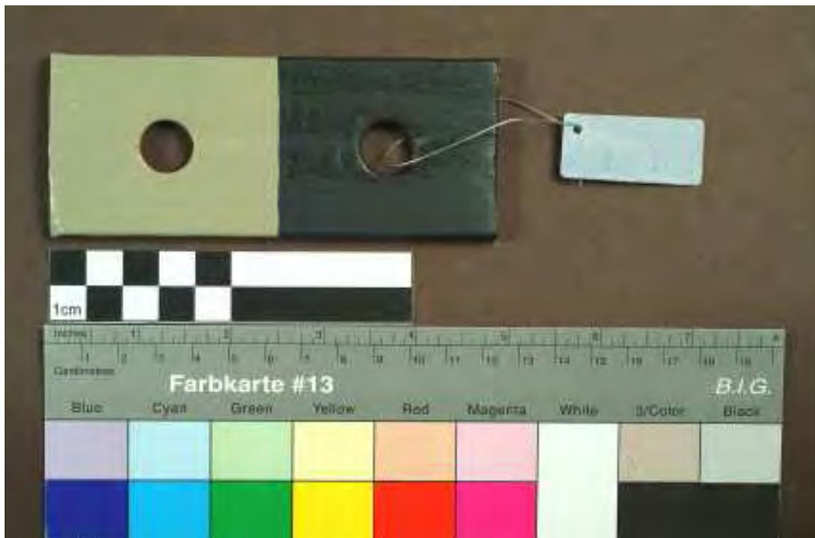
Bild 101 Probestatte LK1 nach der künstlichen Bewitterung im Kondenswasserschrank.
