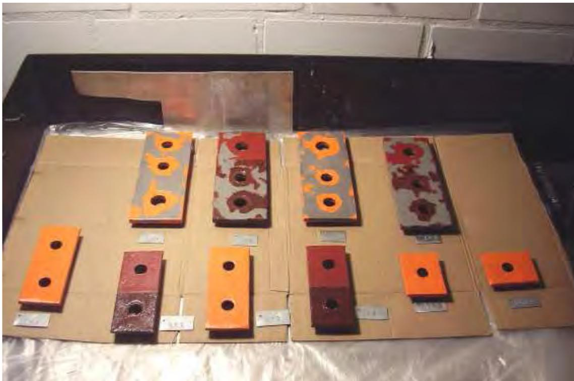
Bild 89 (Abb. 47) Auftrag der jeweiligen Grundbeschichtung auf die Probeplatten.
