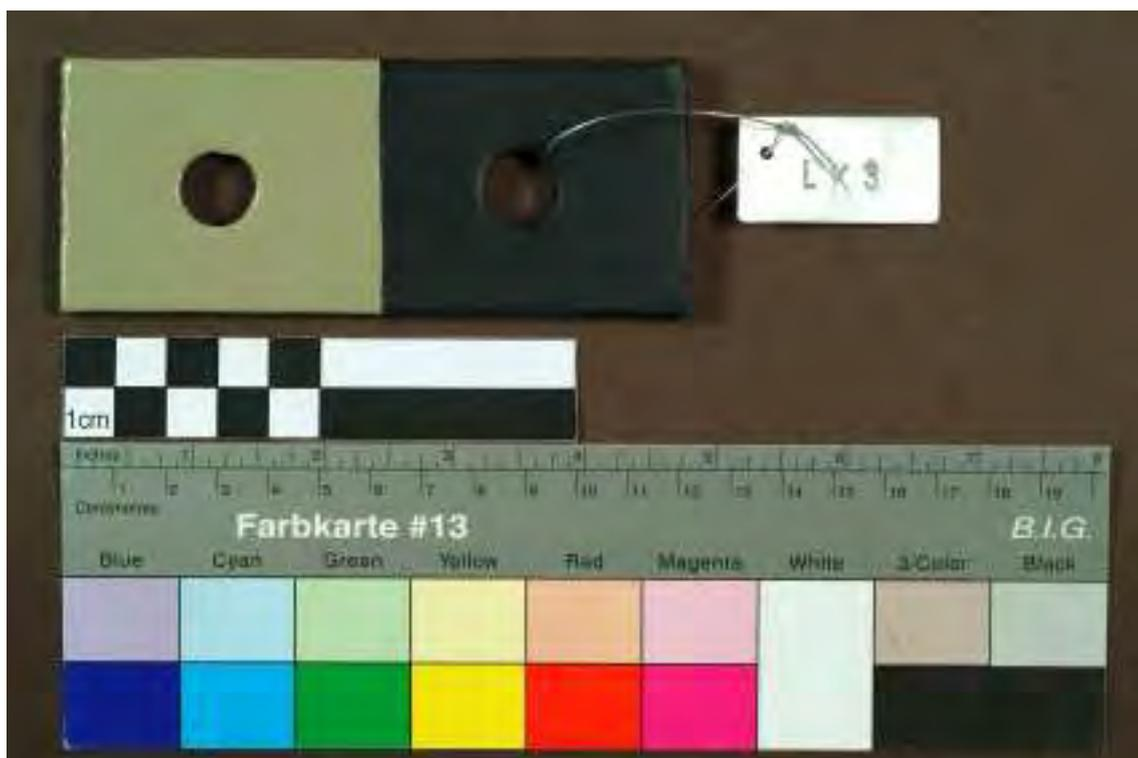
**Bild 93** Neubeschichtung der Probeplatte LK3 mit Öl-Bleimennige und Alkyddecklack (li. System 2), sowie mit Öl-Bleimennige und Öllack (re. System 1).
