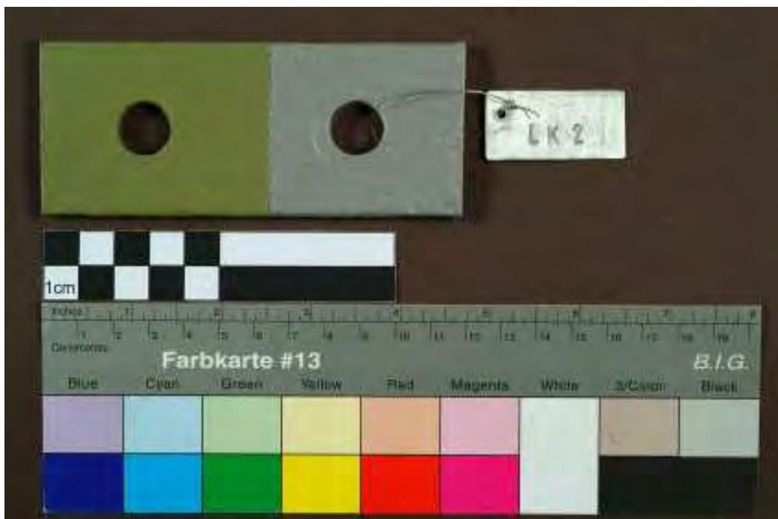
**Bild 92** Neubeschichtung der Probeplatte LK2 mit Zinkphosphatgrundierung und Alkyddecklack (li. System 3), sowie mit dem EK-PUR System (re. System 4).
