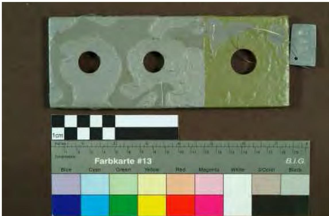
**Bild 98** Ausfleckungsarbeiten auf der Probeplatte LG2 mit System 3 (links: EK-PUR-System), System 4a (mitte: EK-PUR-System) und System 4 (rechts: Zinkphosphatgrundierung und Alkydharz).
