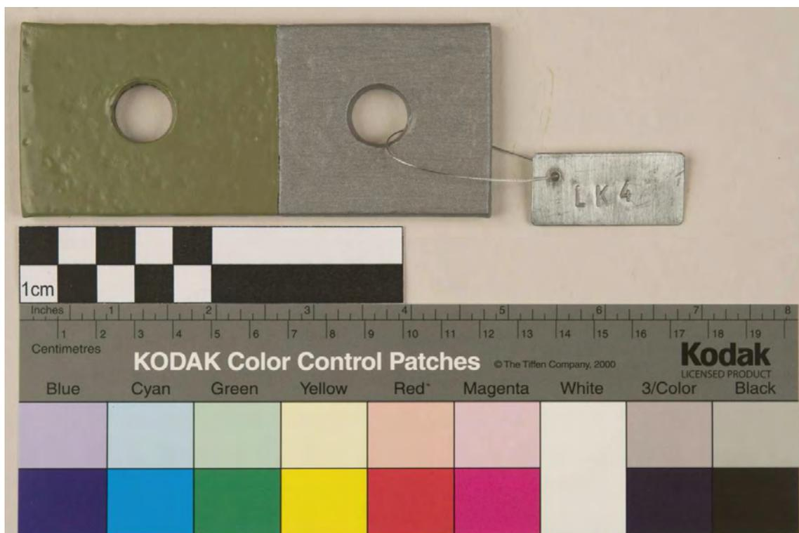
**Bild 94** Neubeschichtung der Probeplatte LK4 mit Zinkphosphatgrundierung und Alkyddecklack (li. System 3), sowie mit dem EK-PUR System (re. System 4).
