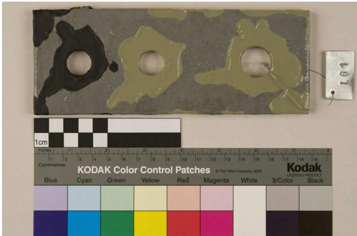
**Bild 97** Ausfleckungsarbeiten auf der Probeplatte LG1 mit System 1 (links: Öl-Bleimennige, Öllack), System 2 (mitte: Öl-Bleimennige, Alkydharz) und System 2a (rechts: Öl-Bleimennige, und dreifacher Alkydharz-Auftrag).
