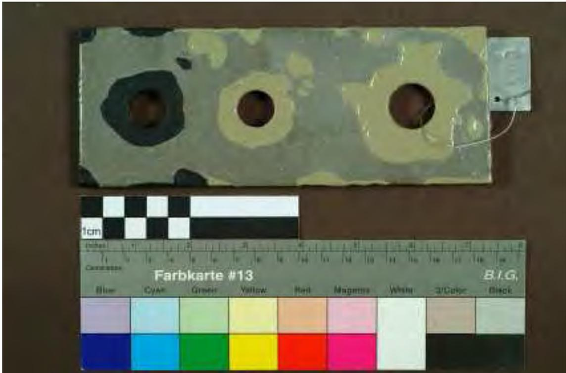
**Bild 99** Ausfleckungsarbeiten auf der Probeplatte LG3 mit System 1 (links: Öl-Bleimennige, Öllack), System 2 (mitte: Öl-Bleimennige, Alkydharz) und System 2a (rechts: Öl-Bleimennige und dreifacher Alkydharz-Auftrag).
