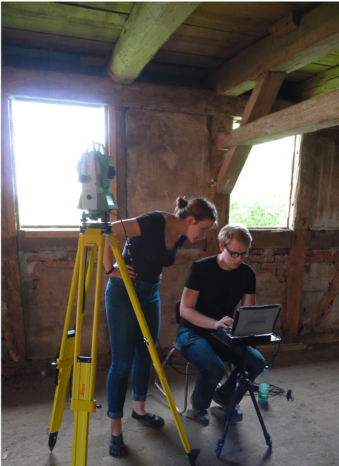
Abb.8 Arbeiten mit der Totalstation
