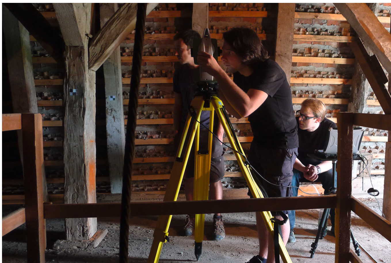
Abb.53 Arbeiten mit der Totalstation
