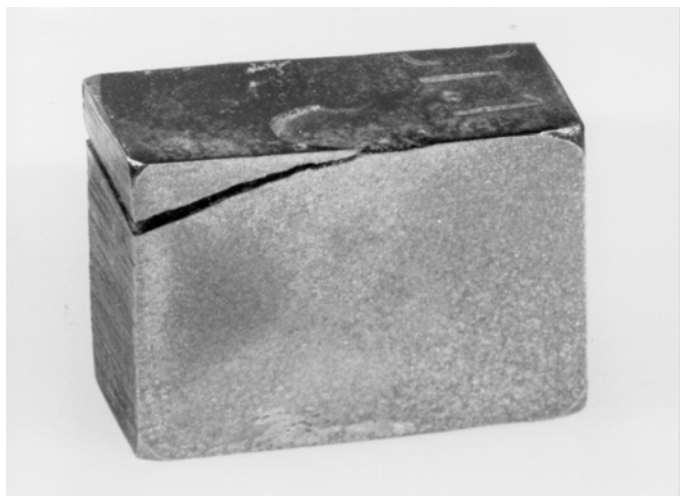
Bild 4: Squat – aus der Schiene herausgetrennt.
