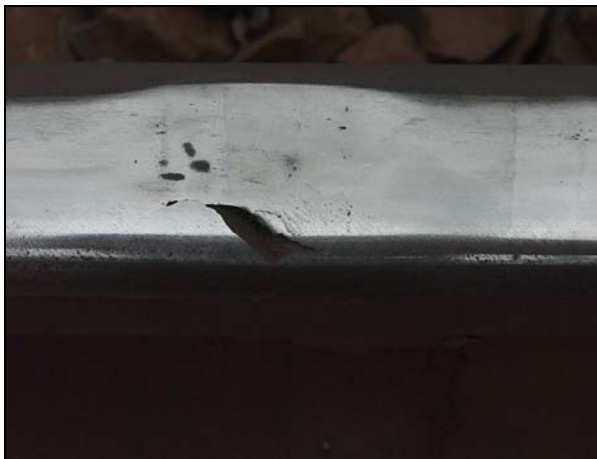
Bild 3: Abblätterungen, verursacht durch Head Checks Bild 4: Schienenbruch, verursacht durch Head Checks
