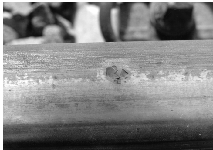
Bild 9: Unregelmäßig geformter, periodischer Eindruck.
