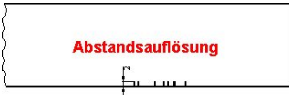
Bild 6a: Testkörper mit Testschnitten gleicher Tiefe [1]
