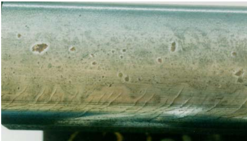
Bild 1: Grobe Head-Checks an der Fahrkante.
