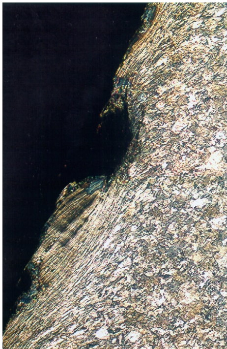
Bild 6: Metallographischer Schliff - Vergrößerung 100x - Ausbruch an der Fahrkante.
