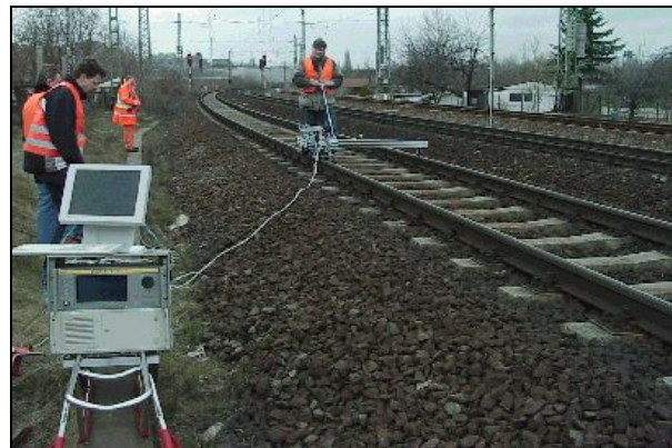
Bild 12: Einsatz der Draisine im Gleis [2]
