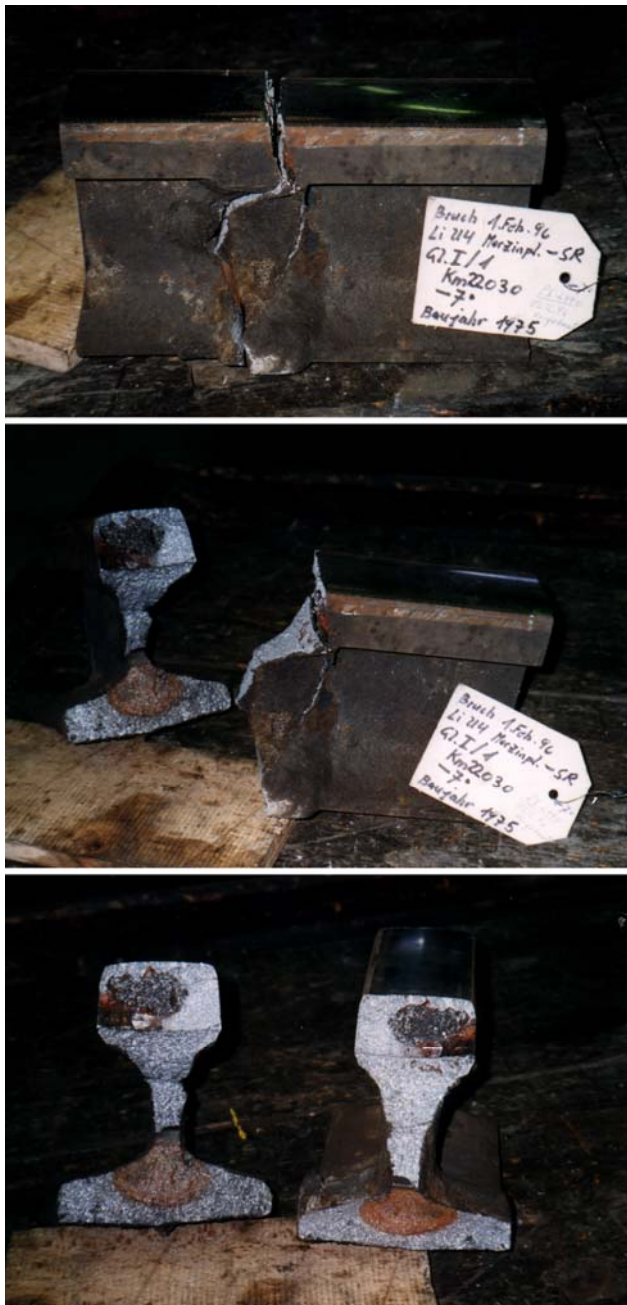
Bild 6: Bruch einer Schweißung bei einem Laschenloch (welded fish-bolt hole)
