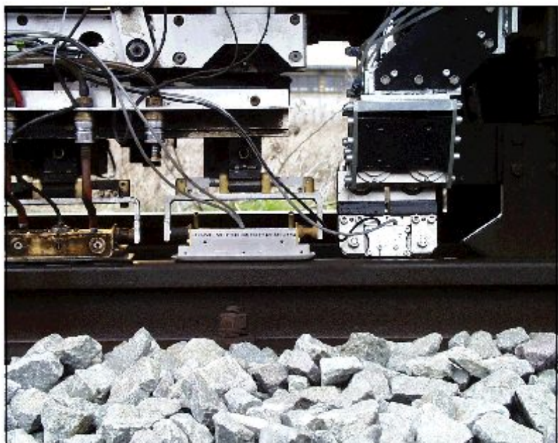
Bild 13: Vorrichtung zur Anbringung der Wirbelstromsonden an den Schienenprüfexpress
