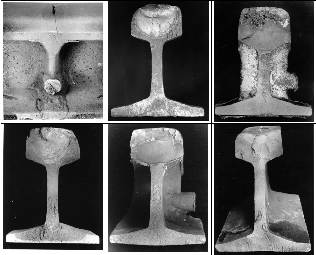
Bild 4: Ansichten von rißgeschädigten Schienenschweißungen und durch Rißbildung im Kopf gebrochener Schienen bzw. Schienenschweißungen.
