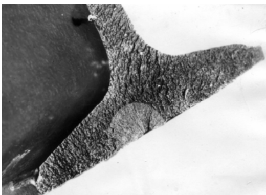
Bild 14: Ansicht der Bruchfläche einer Schiene mit Ermüdungsriß an der Fußunterseite.
