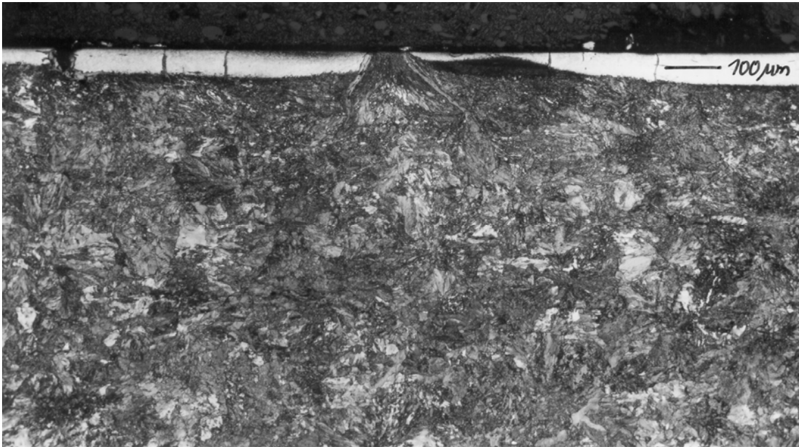
Bild 13: Längsschnitt durch den Riffelberg der Probe P aus Bild 12 – geätzt mit Nital
