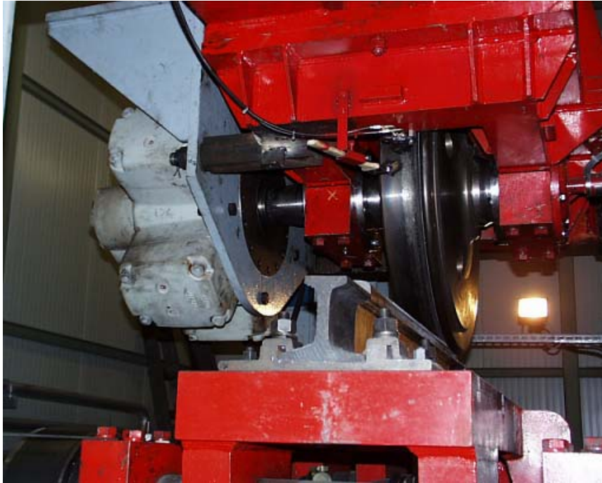
Bild 3: Blick von der Seite auf den Rad-Hydrmotor-Komplex, die Schmiereinrichtung ist ebenfalls zu erkennen.
