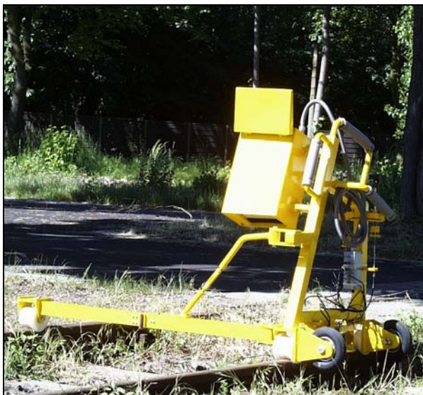
Bild 28a: Vorrichtung zur Spannungsmessung an Schienen
