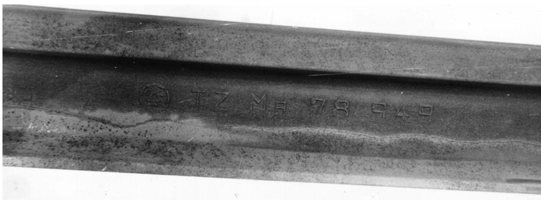
Bild 7.3: Von einem Walzfehler im Schienensteg ausgehender Ermüdungslängsriß.
