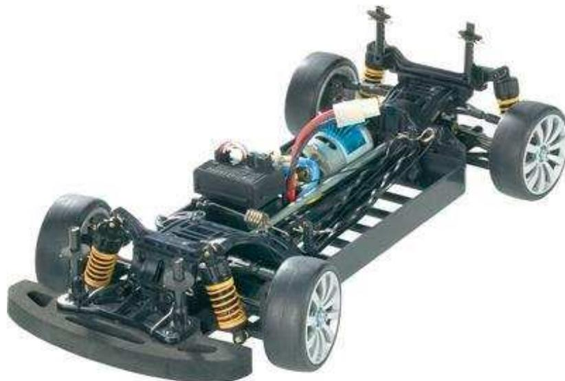
Abbildung: 1.1-2 Modellfahrzeug im Maßstab 1:10
