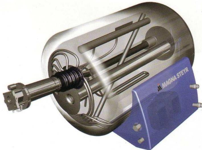
Abbildung 3.1-5: LH<sub>2</sub>-Tanksystem für automotive Anwendung [15]
