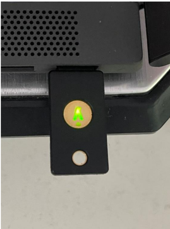
Abbildung 26: Nach der Eingabe des PINs wird der Benutzer aufgefordert, den FIDO2-Stick zu berühren, wenn dieser blinkt, um die Authentifizierung abzuschließen
