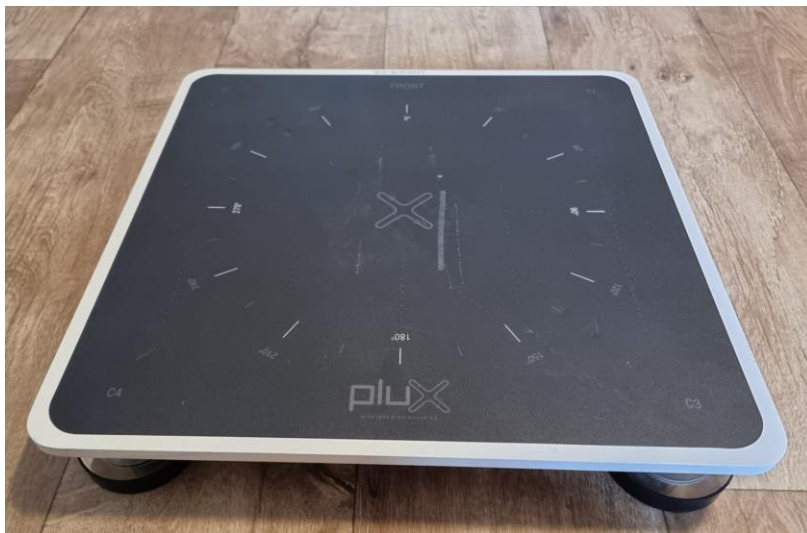
Abbildung 5: Um die physische Komponente in die Trainingseinheit einzubringen, wird eine Kraftmessplatte von „BioPlux“ verwendet
