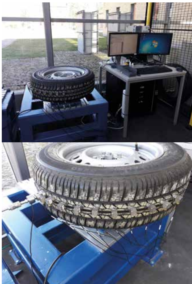
Abbildung 5.49: Modalanalyseprüfstand (oben) und triaxiale Beschleunigungssensoren (unten)
