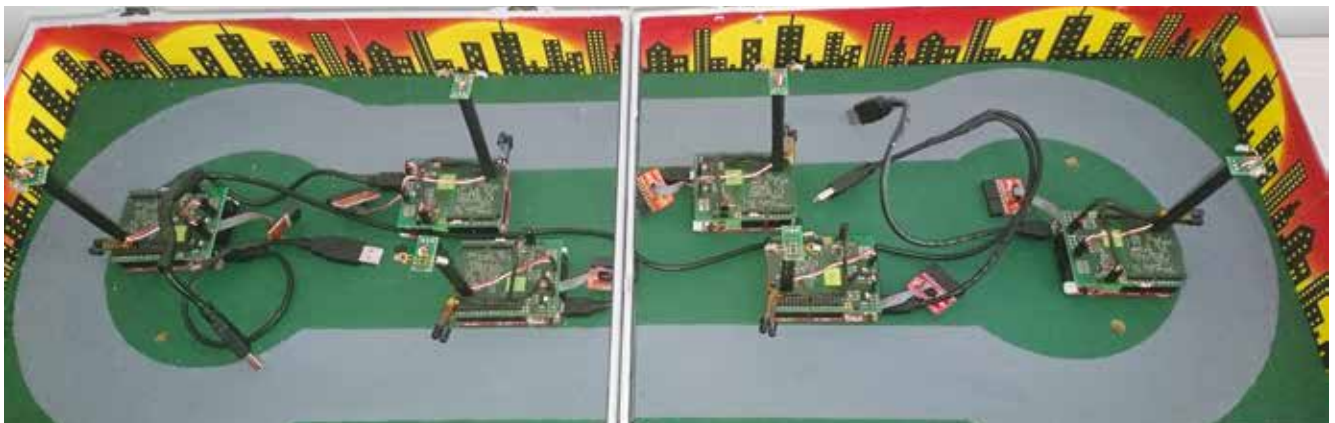
Abbildung 5.1: Prototyp eines optischen Netzwerks als Modell mit mehreren Leuchten
