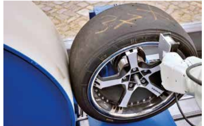
Abbildung 5.48: Prüfeinrichtung des rollenden Rades
