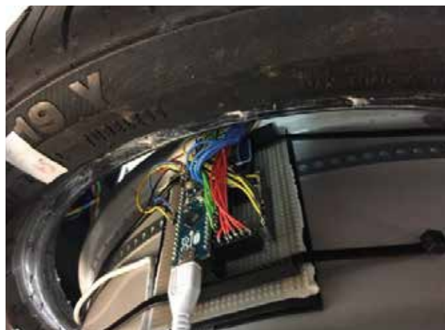
Abbildung 5.45: Messaufbau im Reifeninneren
