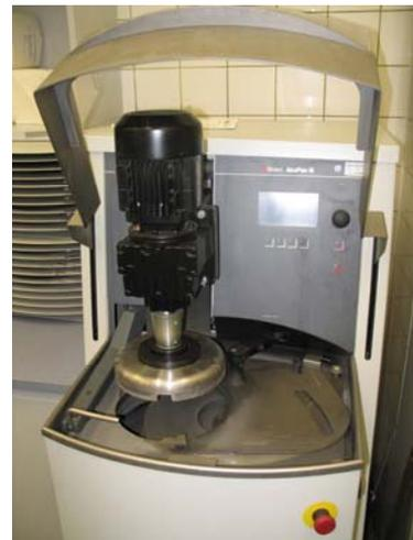
Abb. 24 Planschleifmaschine
