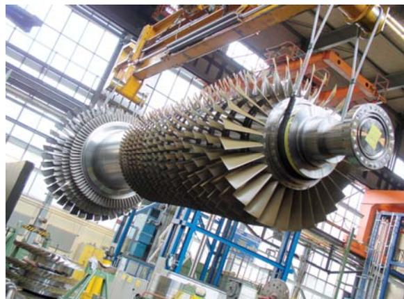
**Abb. 7** Gasturbinenläufer
