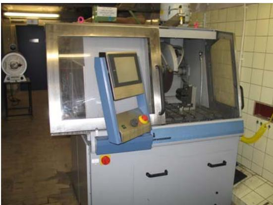
**Abb. 22 Nasstrennschleifmaschine**
