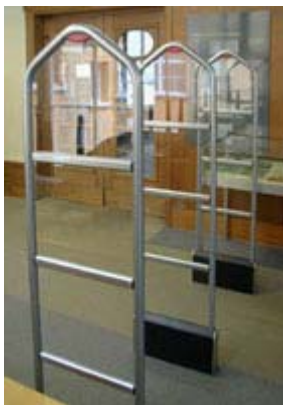
Abb. 10: Lesegerät mit großer Reichweite als Ein- bzw. Ausgangsschleuse 87
