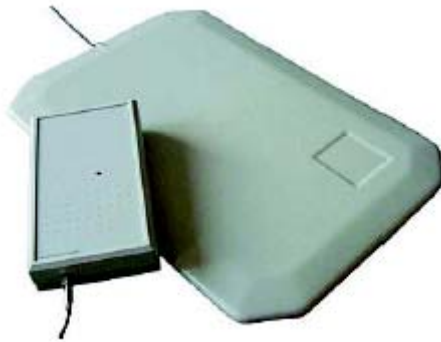
Abb. 11: Lesegerät mit mittlerer Reichweite (rechts) und Übertragungseinheit (links) 88
