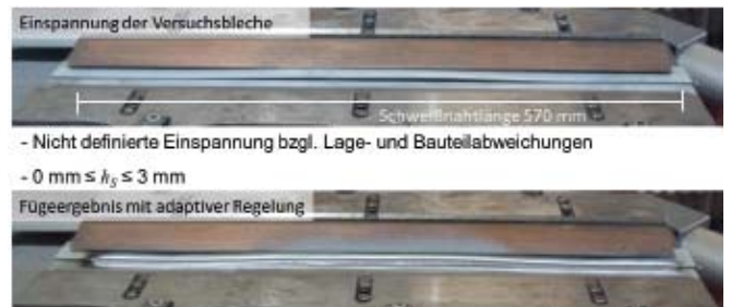
Abbildung 4: Fügeergebnis mit adaptiven Regelung beim MSG-Schweißen mit 3 mm Spalt
