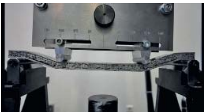
Abbildung 1: 4-Punkt-Biegeversuch, die Probe versagt durch Kernbruch in den Bereichen zwischen Auflagern am Rand und den von oben wirkenden Druckstücken
