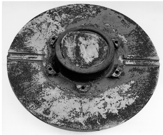
Bild 26: Durch Kantenpressung an der Bremsscheibenhalterung gebrochene Eisenbahnachse eines Triebwagens der Deutschen Reichsbahn. [40]
