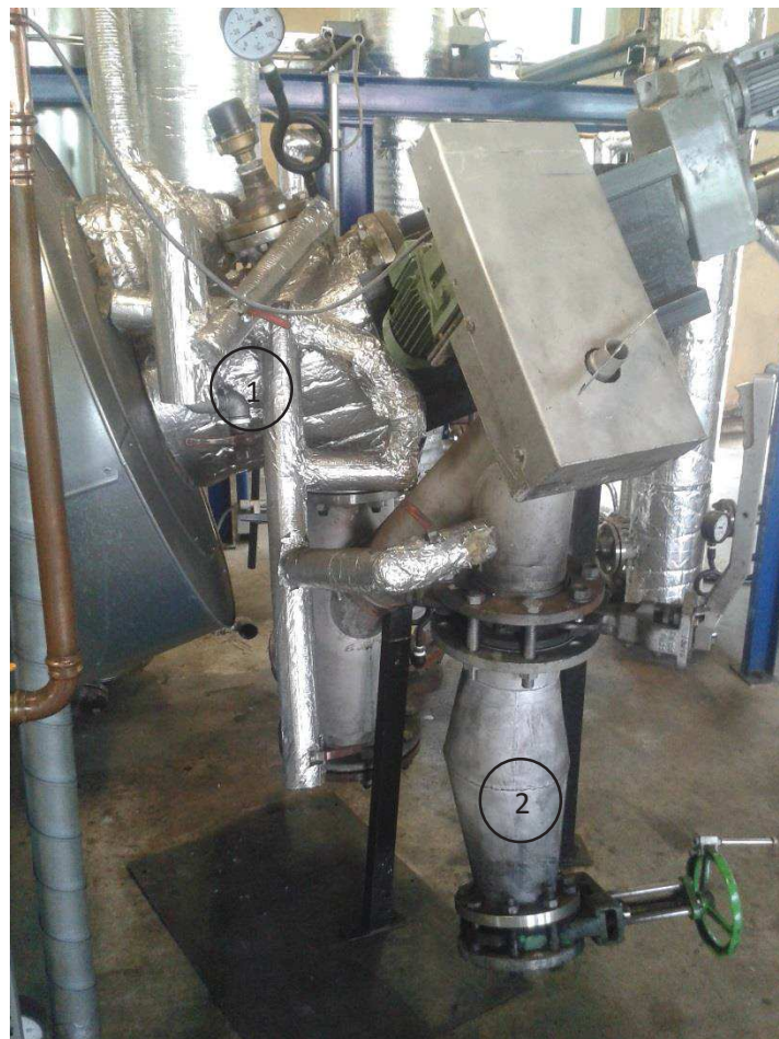
Abbildung 24: Nachreaktor (1) mit Abzug des Kokses (2)
