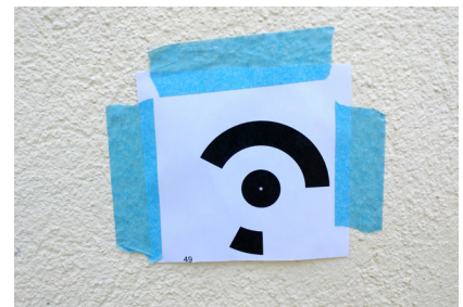
Fig. 3: Agisoft - Messmarke; die Structure-from-Motion Software Agisoft-Metashape erkennt in der Fotografie den Passpunkt.
