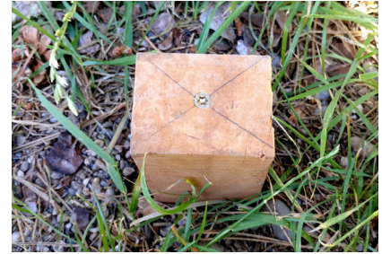
Fig. 1: Messpunkt für das Zebhorizon; auf einer Holzschraube wird das Prisma des Tachymeters aufgesetzt.
