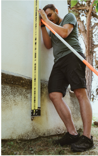
Fig. 6: Aufsetzen der Invar-Latte auf einen Höhenbolzen
