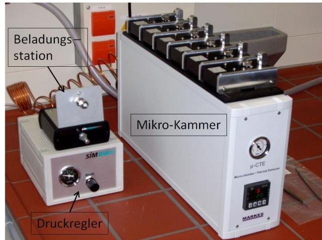
Abbildung 7.2: Die Mikro-Kammer mit Druckregler und der Beladungsstation für die Thermodesorptionsröhrchen
