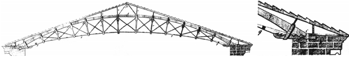
Abb. 46: Vorschlag VOITS für einen gusseisernen Binder [ 263]
