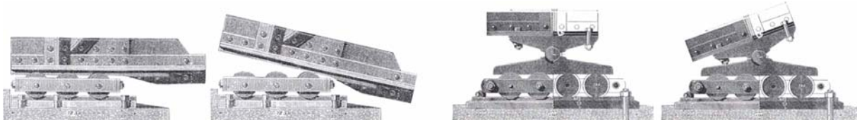
Abb. 71: Gegenüberstellung des Kippverhaltens; Links: Flächenlager, Rechts: Kipplager
