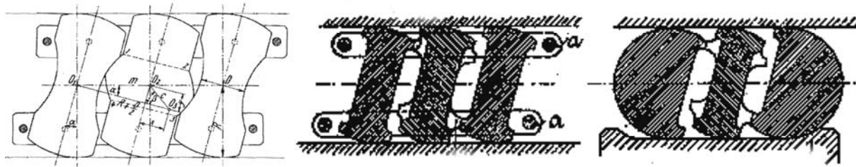
Abb. 67: Kippsichere Lager; Links: Vorschlag von HERZKA [ 49], Mitte/Rechts: Aus dem Patent BERNHARDS [ 587]
