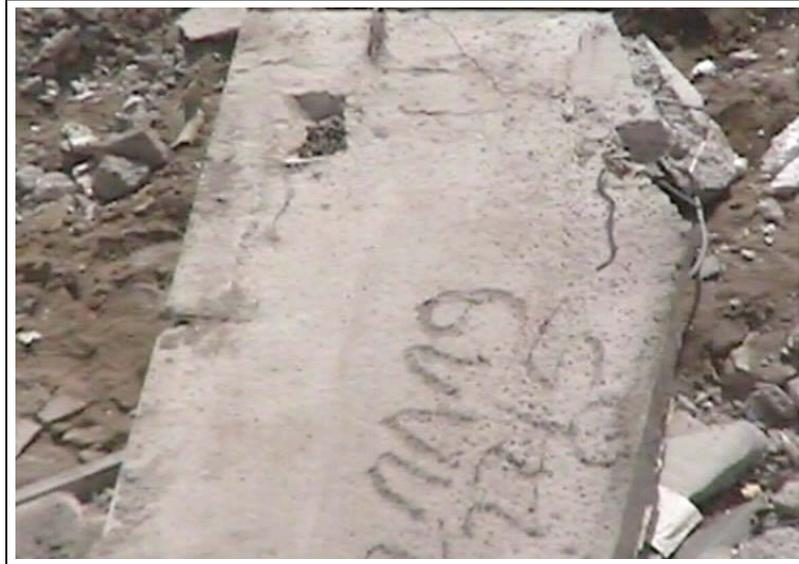
Abb. 7.10: Element D 1/10/65: Bruch der Tragöse bei der Demontage
