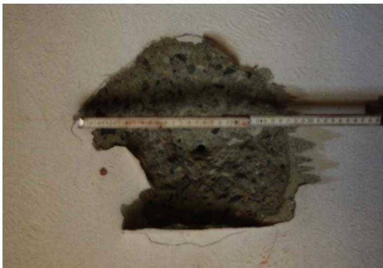
Abb. 2: Ausbruch des Untergrundes (Betonversagen) durch Überlast bei einem Schraubanker
