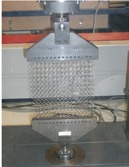
Abb. 4-33 Geflechtsprobe mit 25 freien Ringreihen der Geflechtsgröße G9
