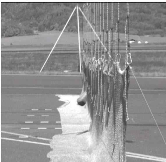
Abb. 5-15 Zeitlicher Verlauf eines Großkörpereinschlages bei 95 km/h in ein abgehangenes Ringgeflecht
