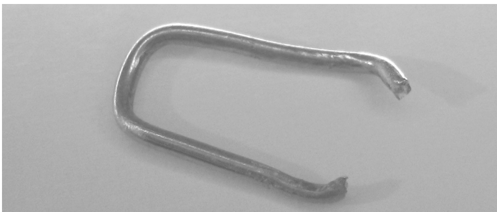
Abb. 4-35 Deformierter Einzelringes der Größe G9 nach Versagen
