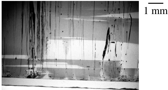
Abb. 5.1: Längsschnitt (Lichtmikroskop, Durchlicht) mit Grenzfläche und diversen Kristallfehlern
