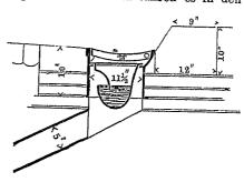
dischen Abzugskanal, der auch die Häuser entwässert. Um die Ausdünstungen des Kanals abzusperren, erhal-ten diese Kasten während des Sommers durch einen, gleichfalls in Gusseisen oder aus Eisenblech hergestellten Einsatz, wie neben-
