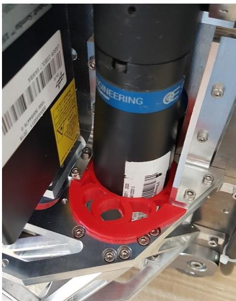
Abbildung 91: Foto von 3D gedruckter radialer Lagerung des Objektivs
