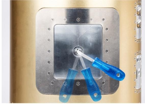
*Abbildung 125: Außenansicht mit Andeutung des Vierkantwerkzeugs und dessen Bewegung beim Schließvorgang*
