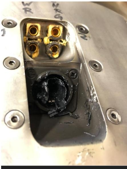
Abbildung 33: Zerstörte Konnektoren nach einem Wiedereintritt
