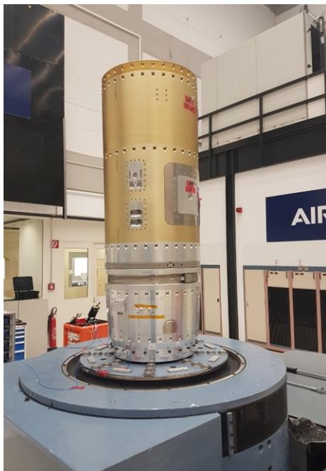
Abbildung 108: Gesamtexperiment auf dem Rütteltisch bei AIRBUS in Ottobrunn
