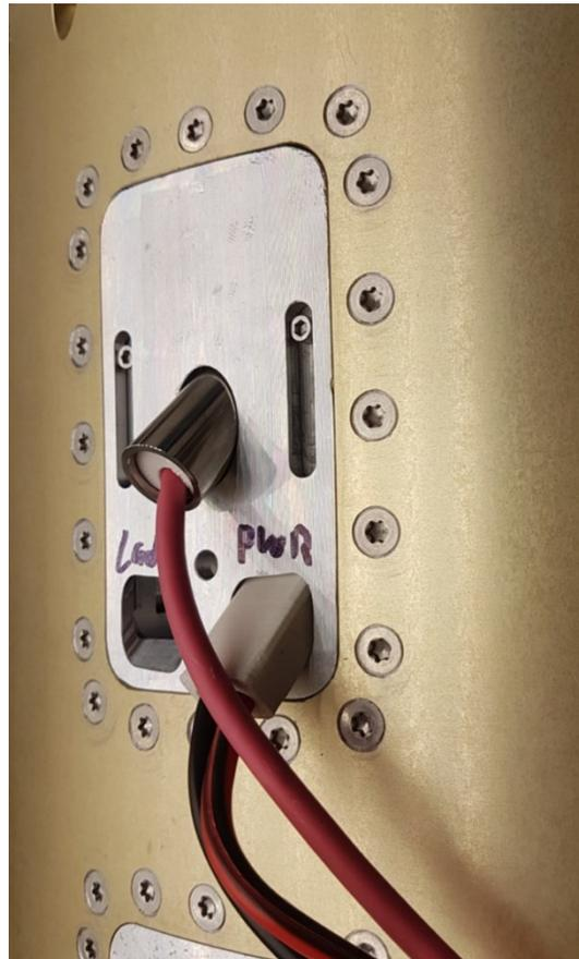
Abbildung 43: Umbilical mit eingesteckten Konnektoren und Rückschlaghülse
